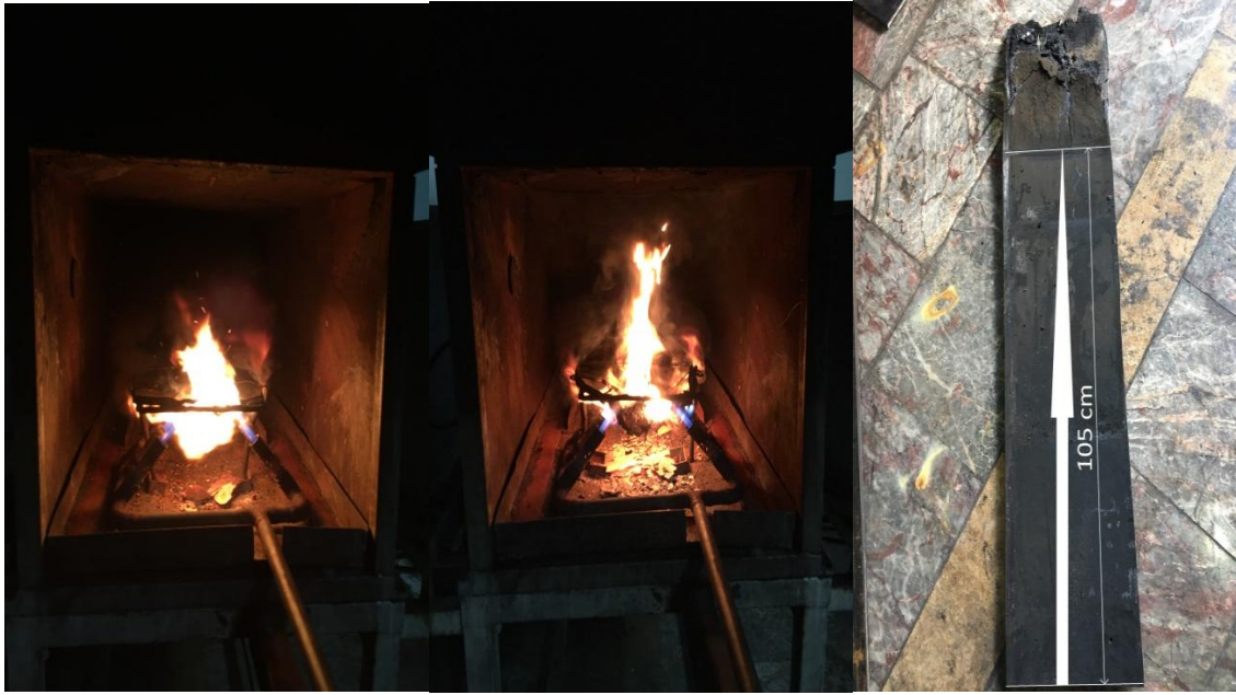
Şekil 4.9 Konveyör band haline gelmiş Sodyum tetraborat pentahidrat'ın test aşamaları ve test sonrası boyu.
