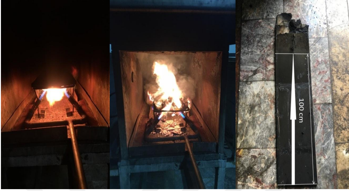
Şekil 4.7 Konveyör band haline gelmiş ATH'ın test aşamaları ve test sonrası boyu.
