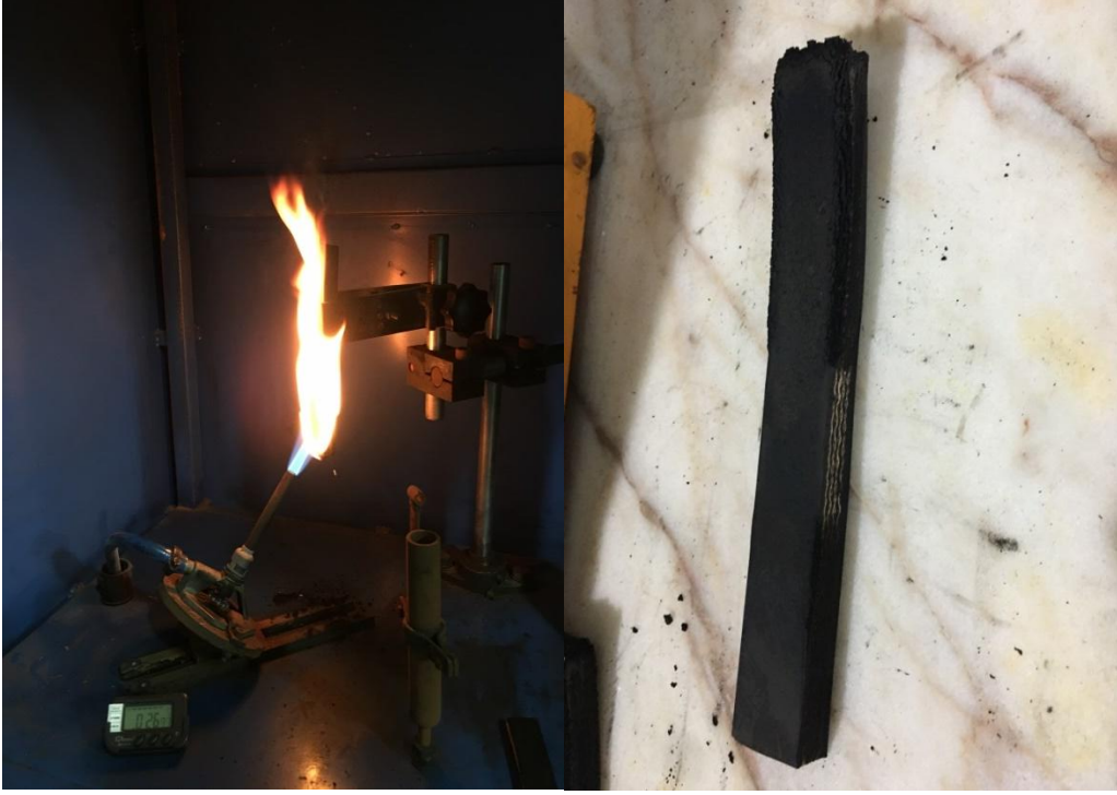
Şekil 4.13 Dekahidrat'ın alev karakteristiği testi ve test sonrası numune görüntüsü.
