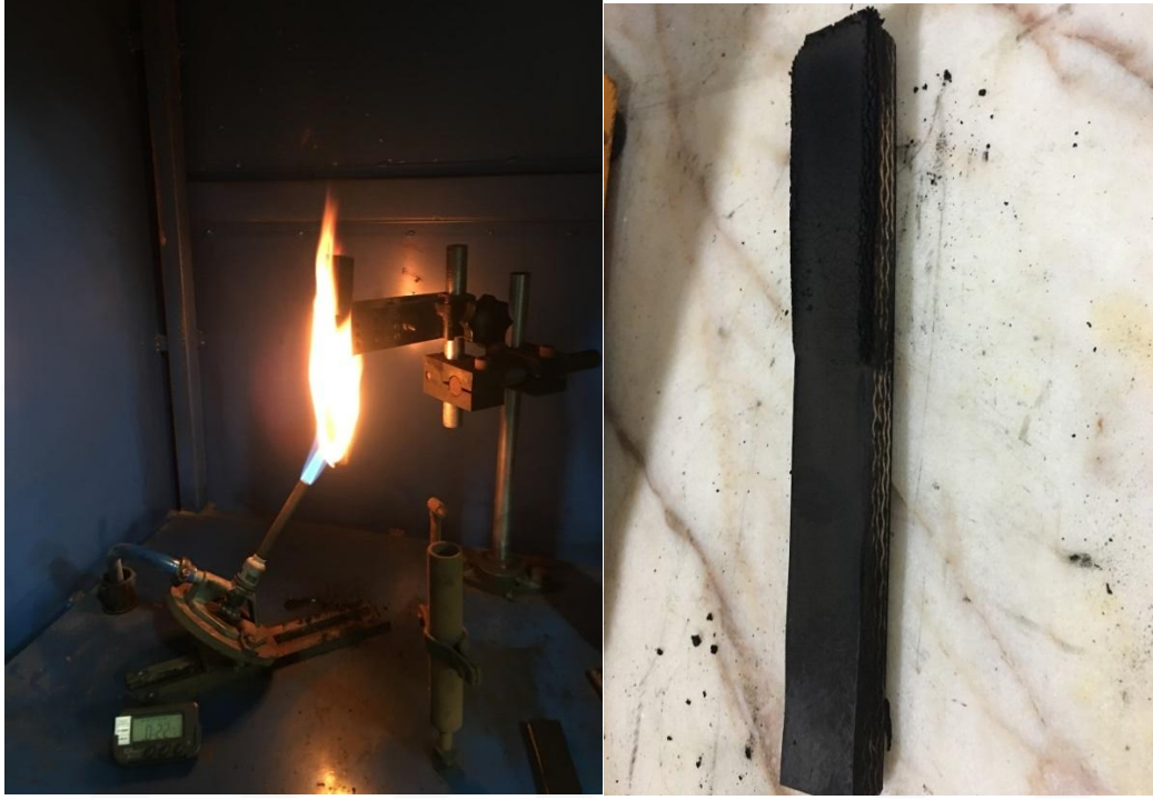
Şekil 4.14 Pentahidrat'ın alev karakteristiği testi ve test sonrası numune görüntüsü.
