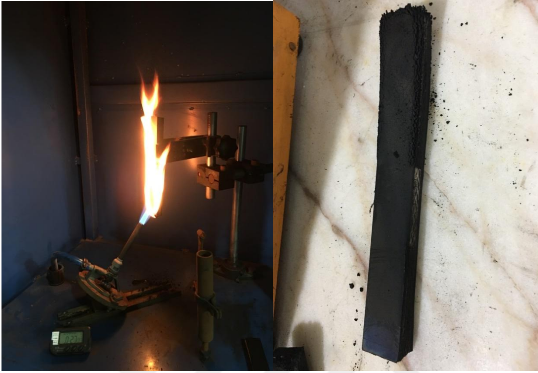
Şekil 4.15 Borik asit'in alev karakteristiği testi ve test sonrası numune görüntüsü.
