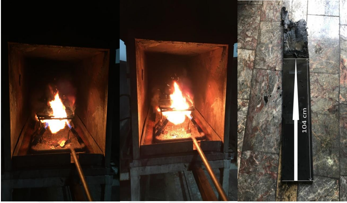
Şekil 4.10 Konveyör band haline gelmiş Borik asit'in test aşamaları ve test sonrası boyu.
