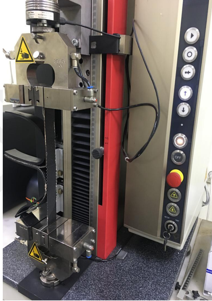
Şekil 4.18 ATH içeren konveyör band numunesinin yapışma mukavemet testi
