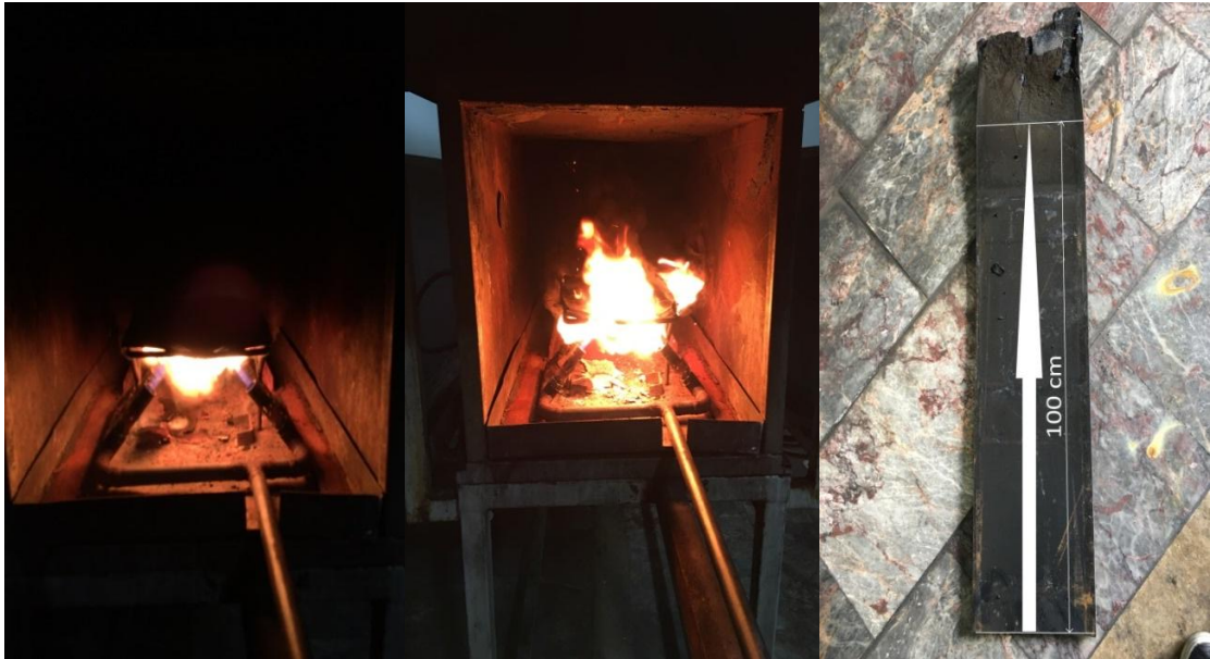
Şekil 4.8 Konveyör band haline gelmiş Sodyum tetraborat dekahidrat'ın test aşamaları ve test sonrası boyu.
