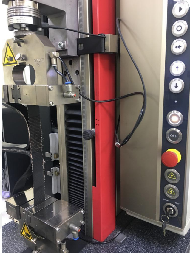
Şekil 4.22 Pentahidrat içeren konveyör band numunesinin yapışma mukavemet testi.
