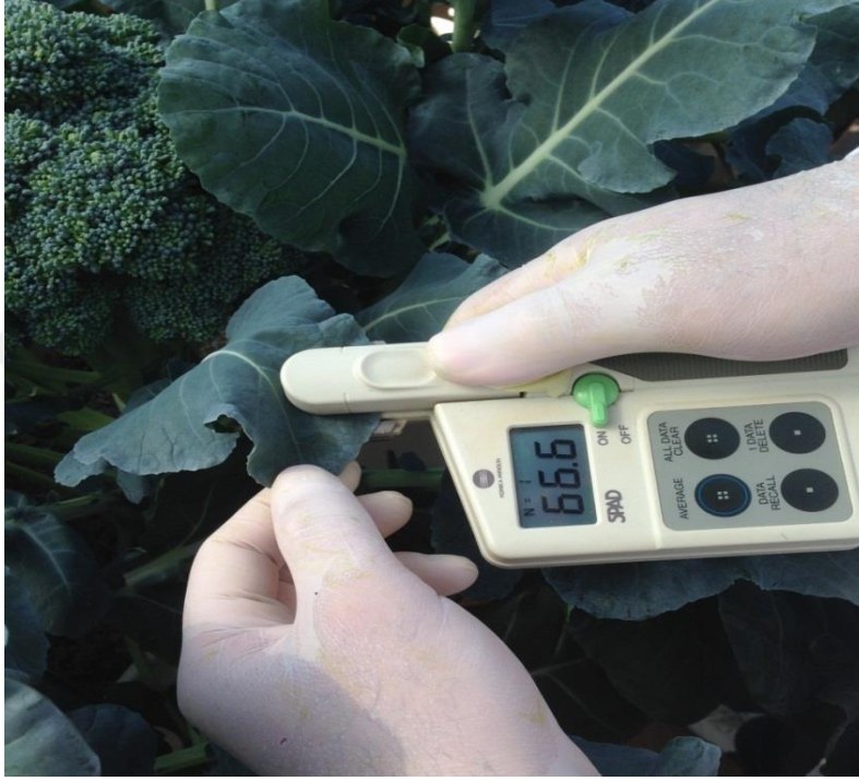
Şekil 3.23. Yapraktaki klorofil miktarının belirlenmesinden genel bir görünüm
