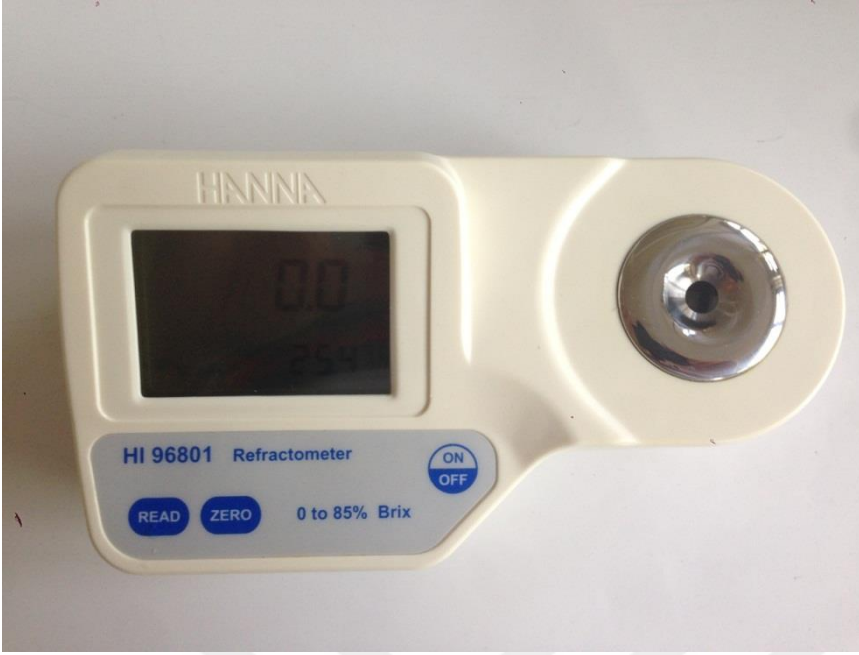
Şekil 3.35. Hanna HI 96801 dijital refraktometreye ait bir görünüm
