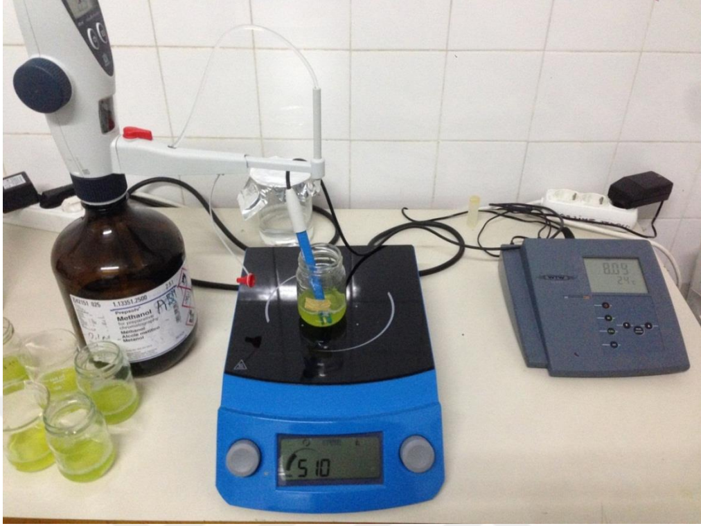
Şekil 3.36. Brokkolilerde TEA miktarını belirlemek için yapılan titrasyon işleminden bir görünüm
