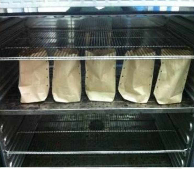
Şekil 3.27. Havalandırılmalı kurutma dolabından bir görünüm
