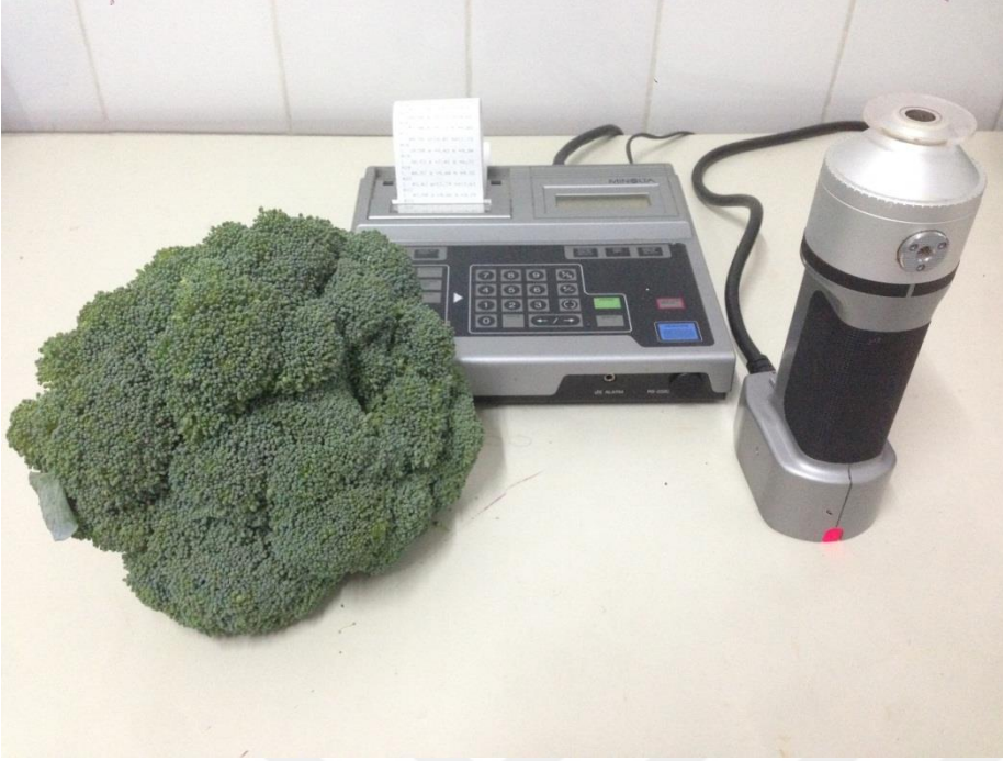
Şekil 3.32. Taçların renk ölçümünün yapıldığı MINOLTA CR-200 kromametresi
