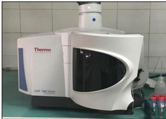
Şekil 3.11. ICP-OES cihazından bir görünüm
