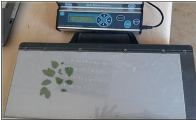
Şekil 3.6. Yaprak alanı ölçümünden bir görünüm
