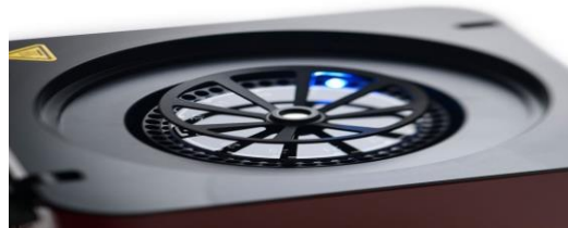
Şekil 3-4: MicqPCR tüp koruyucusu yerleştirme şekli
