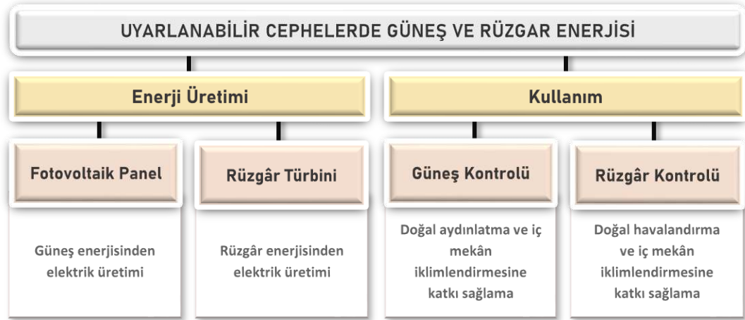
Şekil 4.8. Uyarlanabilir Cephelerde Güneş ve Rüzgâr Enerjisinden Yararlanma Çeşitleri (Yazar tarafından oluşturulmuştur.)
