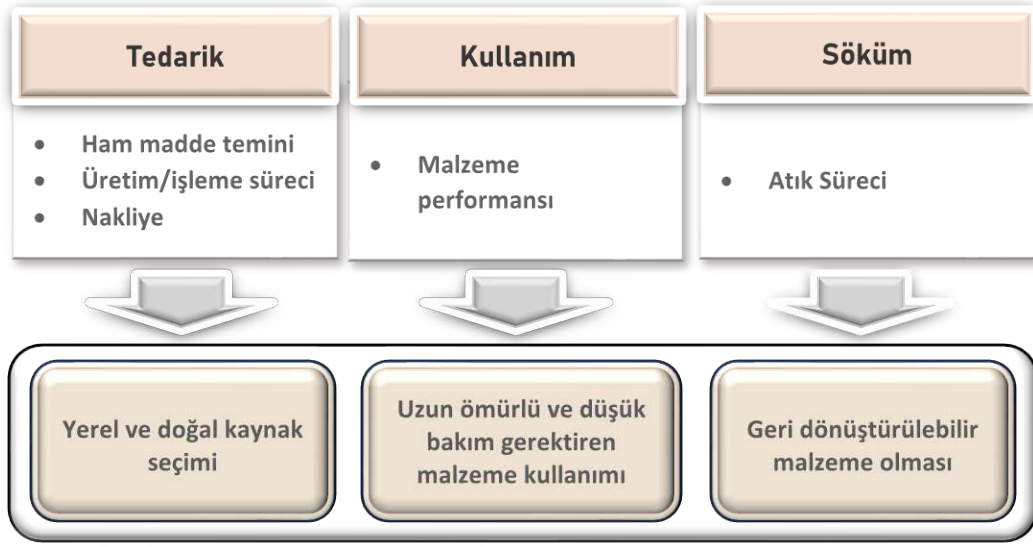
Şekil 4.10. Cephede kullanılacak sürdürülebilir malzemenin kriterleri (Yazar tarafından oluşturulmuştur.)
