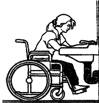
Şekil 5. 101. Duvara monteli lavabo (Reinhold, 1991, s:171)
