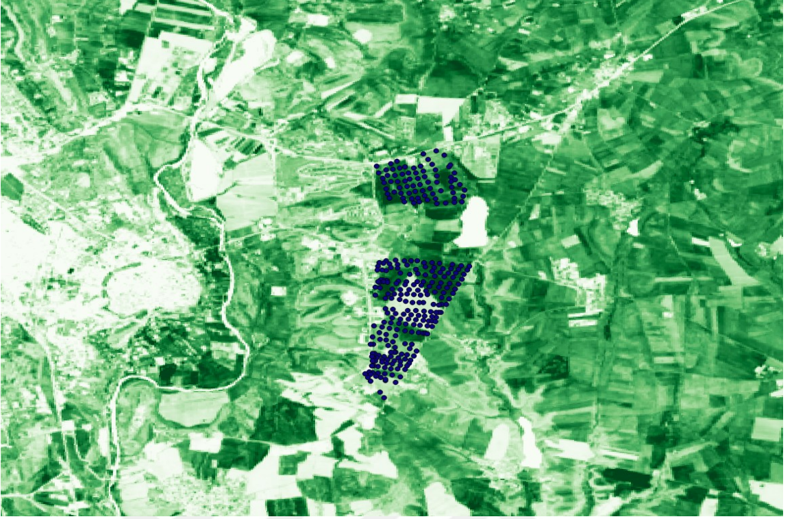
Şekil 4.12. 25.05.2015 tarihli Dicle Üniversitesi tarım alanına ait tek bant yalancı renk katmanı şeklindeki yeşil bant NDVI görüntüsü (GPS verisi işlenmiş hali)
