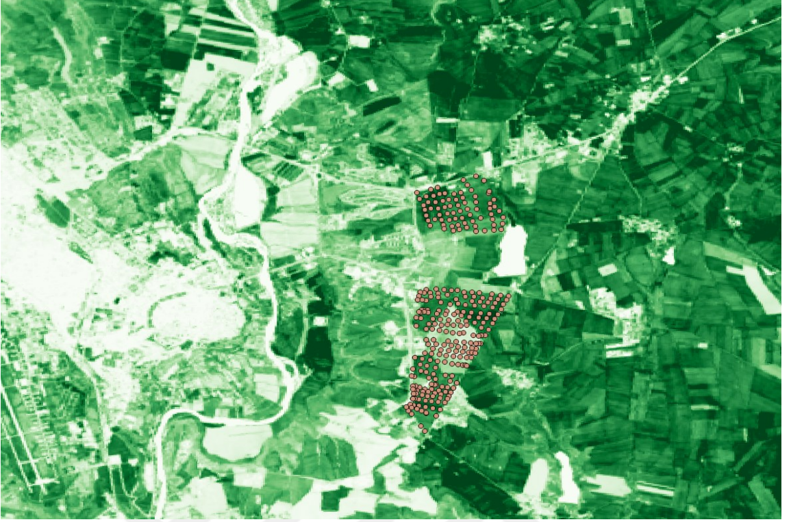
Şekil 4.7. 07.04.2015 tarihli Dicle Üniversitesi tarım alanına ait tek bant yalancı renk katmanı şeklindeki yeşil bant NDVI görüntüsü (GPS verisi işlenmiş hali)
