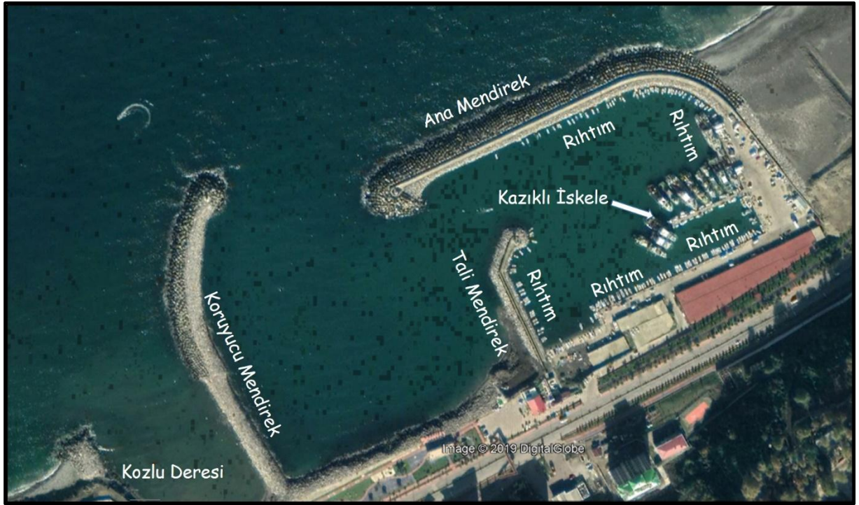
Şekil 4.2 Kozlu Balıkçı Barınağı elemanları.
