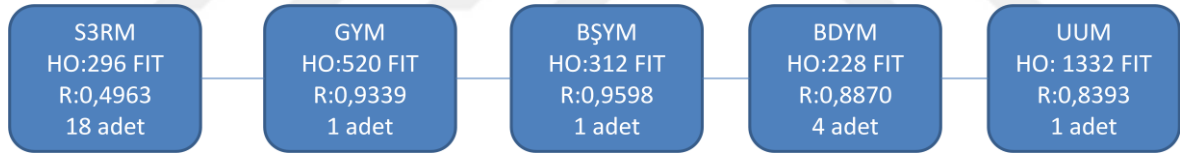
Şekil 4.2. Ön tasarım GKB güvenilirlik blok diyagramı
