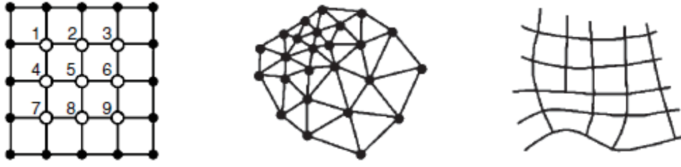
Şekil 2.2. Grid hücre yapısı, düzensiz üçgen ağı yapısı ve kontur çizgileri yapısı (Wilson ve Gallant, 2000; Wilson, 2018).
