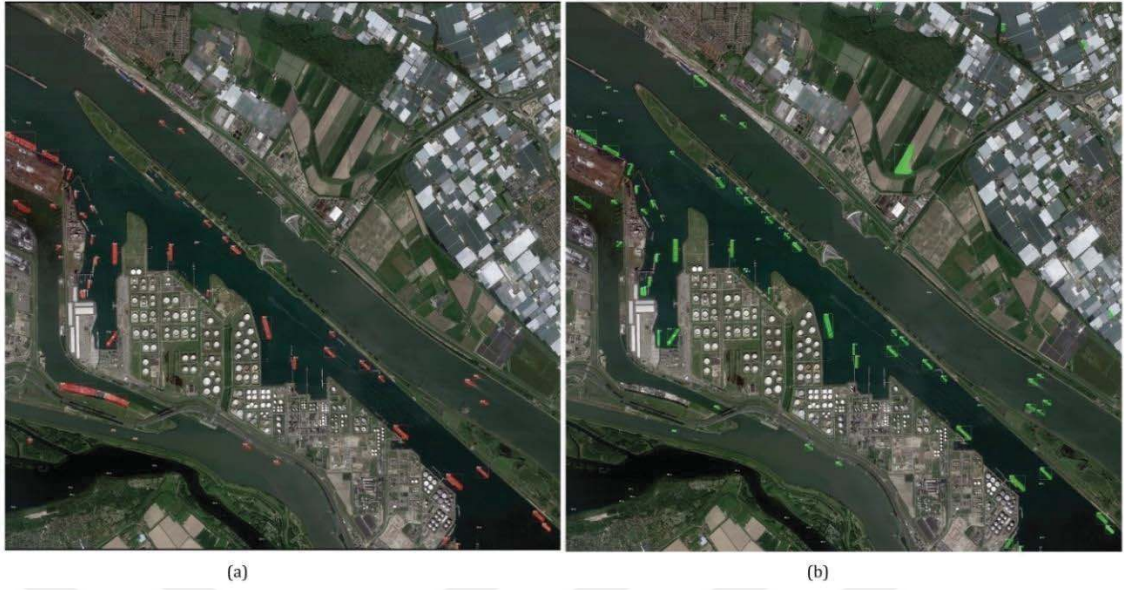
Şekil 5.10. BG-1 görüntüsü içinden bir kesitte a) eğitimde pozitif örneklem sayısı kadar negatif örneklem kullanıldığı modelle yapılan tespit, b) eğitimde sadece pozitif örneklerin kullanıldığı modelle yapılan tespit
