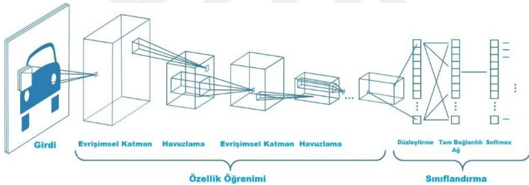
Şekil 3.7 ESA genel mimari yapısı.
