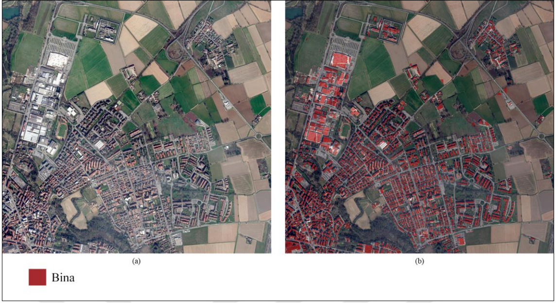
Şekil 68. WV3 uydu görüntüsünün sınıflandırılması (a) çalışma alanı, (b) sınıflandırma sonuçları
