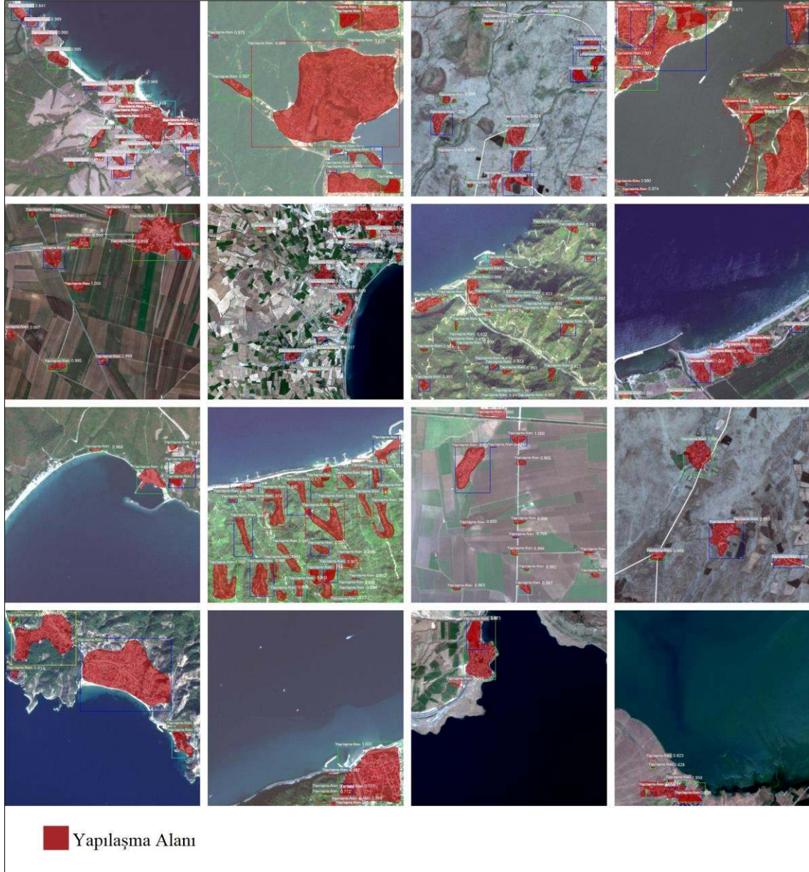
Şekil 52. ResNet50 ile oluşturulmuş modelin sınıflandırma sonuçları
