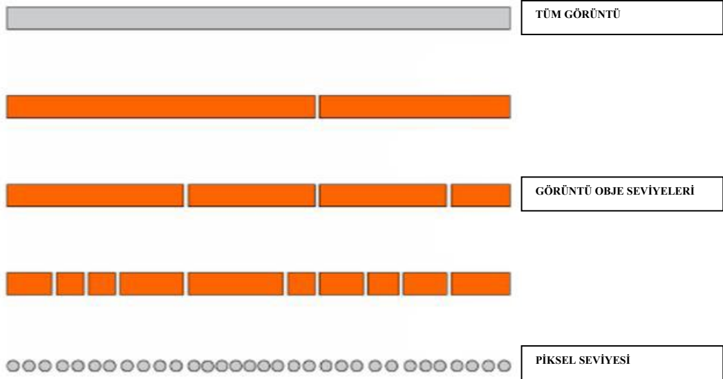
Şekil 3.1: Bölge büyüme algoritması pikselle başlar ve tüm görüntüyü segmentlere ayırır (Definiens User Guide, 2007).
