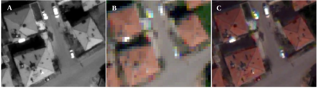
Şekil 4.4: Pankromatik görüntü (A), Multispektral görüntü (B), Pan Sharp görüntü (C).
