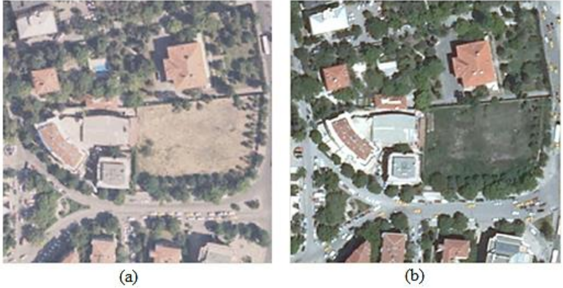
Şekil 2. Analog ve dijital kameralar ile elde edilen ortofotolar (a) Analog, (b) Dijital (Erol & Öner, 2011)
