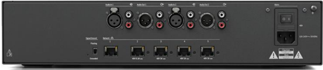
Şekil 50. Dicentis ses işlemcisi arka yüzey bağlantı giriş çıkışları
