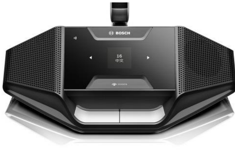
Şekil 46. DCNM-DSL Dil seçicili kongre cihazı.
