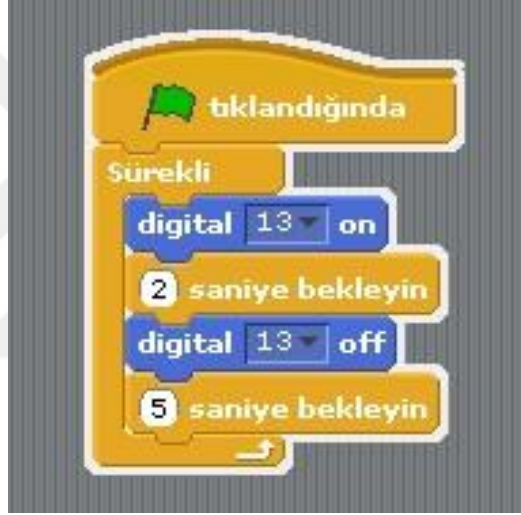
Şekil 19.Led yakma söndürme bloğu
