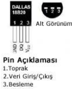
Şekil 3.2. DS1820 Sıcaklık Sensörünün PIN Diyagramı.
