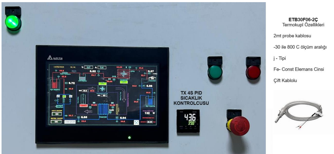
Şekil 4.10. Autonics TX4S PID sıcaklık kontrolcüsü ve termokupl
