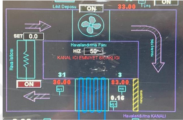
Şekil 4.13. Havalandırma fanı kontrol ve hava hızı ölçme görüntüsü
