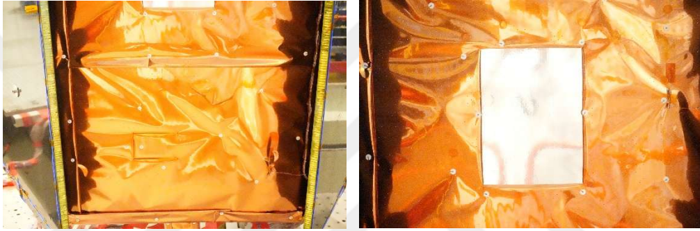
Şekil 3.3. Uydu paneli üzerine montajı tamamlanmış MLI örneği
