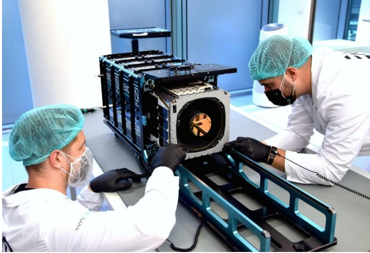
Şekil 2.13 EXOpod Entegrasyon İşlemleri
