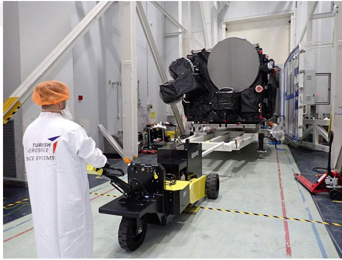
Şekil 2.2 Uyduların Üretim Yerinde Malzeme Nakli (Taşıma) Faaliyetleri (TÜRK SAT 6A)
