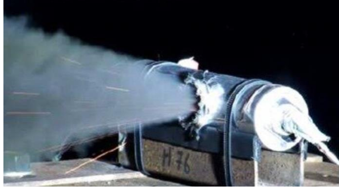
Görsel 5.1. Mikro meteoridin çarpması sonucu batarya üzerinde test görüntüsü ( http-5 )
