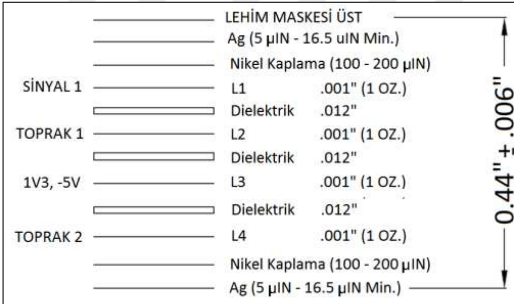
Şekil 4.11. DC Güç kartı kesit bilgisi
