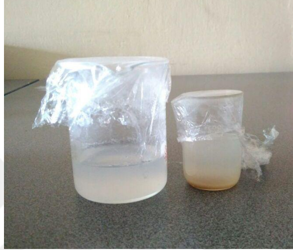
Şekil 3.8. Keratin katkısız solüsyon (soldaki) ve oda şartlarında iki gün bekletilmiş 0,063 g keratin içeren solüsyon
