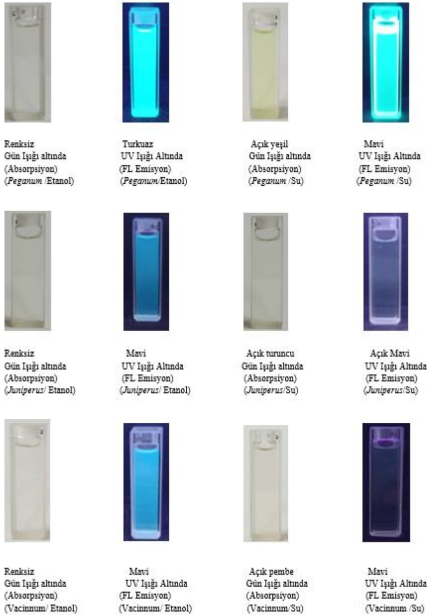
Şekil 4.4. Üzerlik, ardıç ve yaban mersini bitkilerinin suda ve etanolde çözeltilerinin gün ışığında ve UV ışığındaki absorpsiyon ve emisyon görüntüleri.
