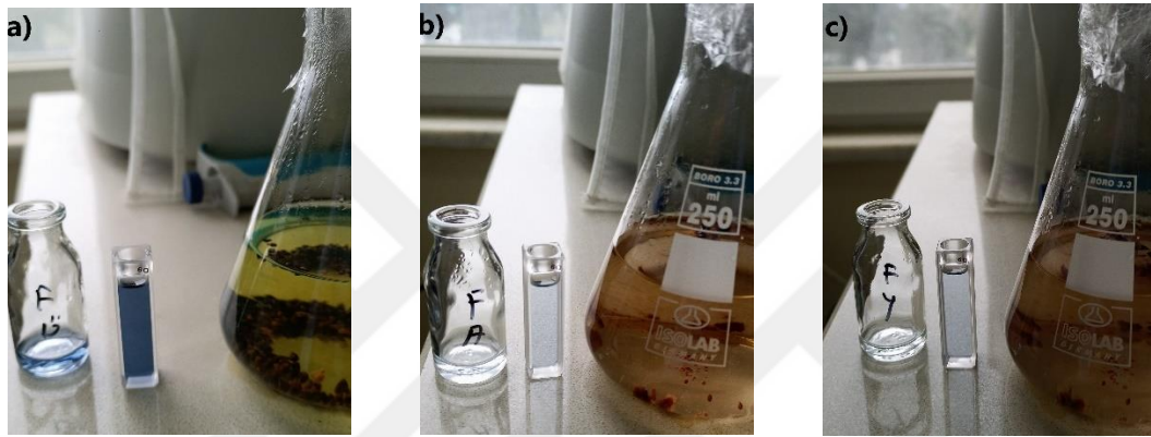
Şekil 4.25. a) Üzerlik, b) ardıç ve c) yaban mersini bitkilerinin 95 °C, 40 dk’ daki sulu ekstrelerinin folin reaktifinin indirgenmesiyle oluşan mavi renk görüntüleri.
