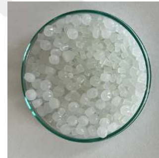
Polimer Granülü (%50) + Masterbatch (%50) karışımı
