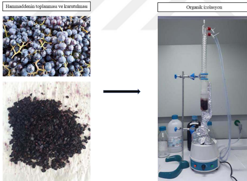
Şekil 3. Selüloz nanokristal izolasyonunun ilk aşamasıdır. Etüv ile kurutulan hammaddenin sokslet aparatı ile organik izolasyonu.
