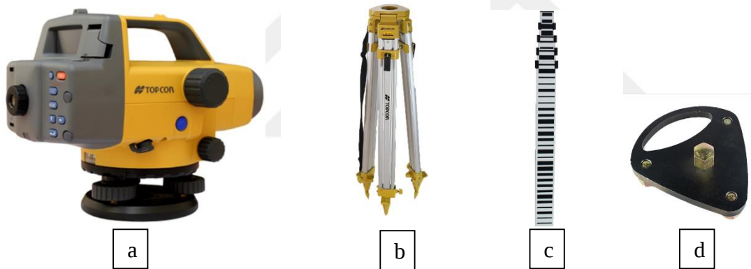
Şekil 4.12. a: Topcon DL-502 elektronik dijital nivo, b: Alet sehпасı, c: Topcon marka alüminyum 5 metrelik mira, d: Mira çarığı
