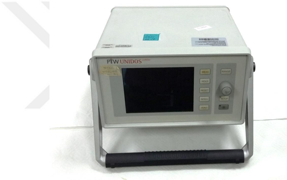
Şekil 3.11. PTW Unidos Weblin marka elektrometre.
