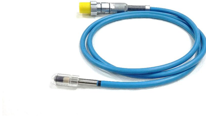
Şekil 3.9. PTW 31010 model 0.125 cc iyon odası.
