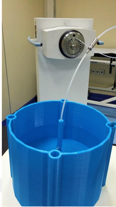
Şekil 4.5. Nokta doz ölçümü için modellenen fantom ve ölçüm düzeneği.
