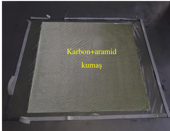
Şekil 6.6. Karbon/aramid hibrid dokuma kumaş
