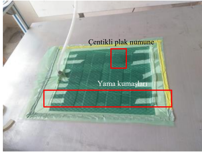
Şekil 6.15. Vakum infüzyon yöntemiyle ıslak yamalı kompozit plak tamiri
