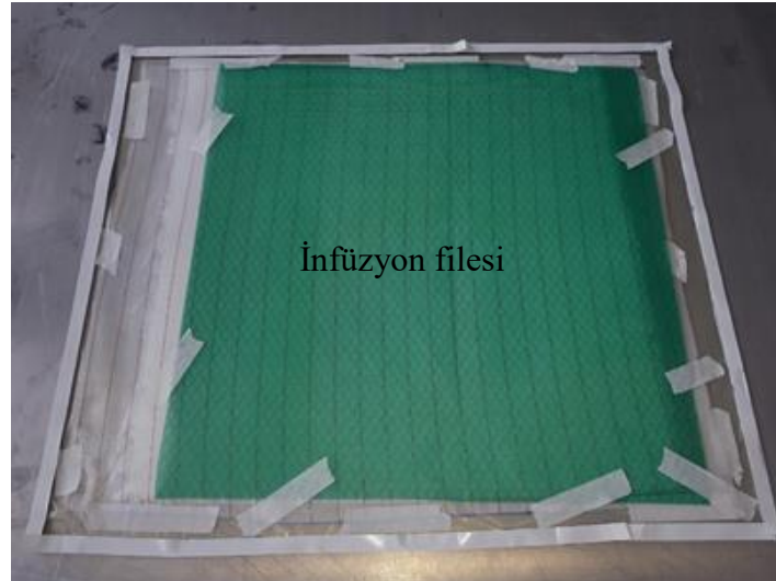
Şekil 6.8. Ayırıcı tabaka (Release film) üzerine serilen infüzyon filesi
