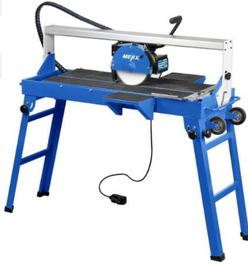
Şekil 6.13. Kompozit plak kesmede kullanılan sulu mermer kesme makinesi
