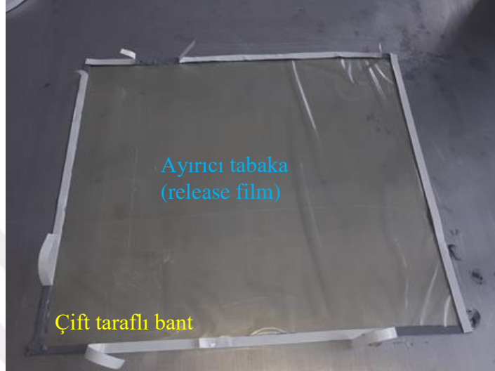
Şekil 6.5. Release filmin ısıtıcı tablaya çift taraflı bant ile yapıştırılması
