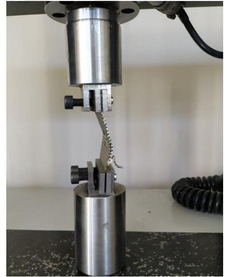
b) Numunelerin burkulma sonrası yandan görünüşü
