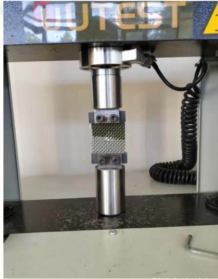
a) Numunelerin burkulma sonrası önden görünüşü
