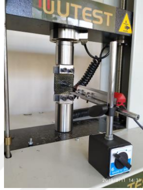
Şekil 6.3. LVDT doğrusal deęişken fark transformatoru
