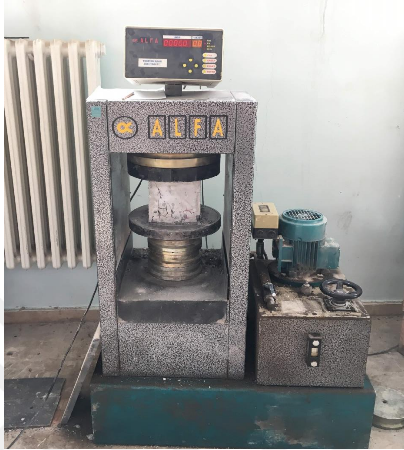
Şekil 3.23. Küp numunelerin preste basınç dayanımı testine tabii tutulması
