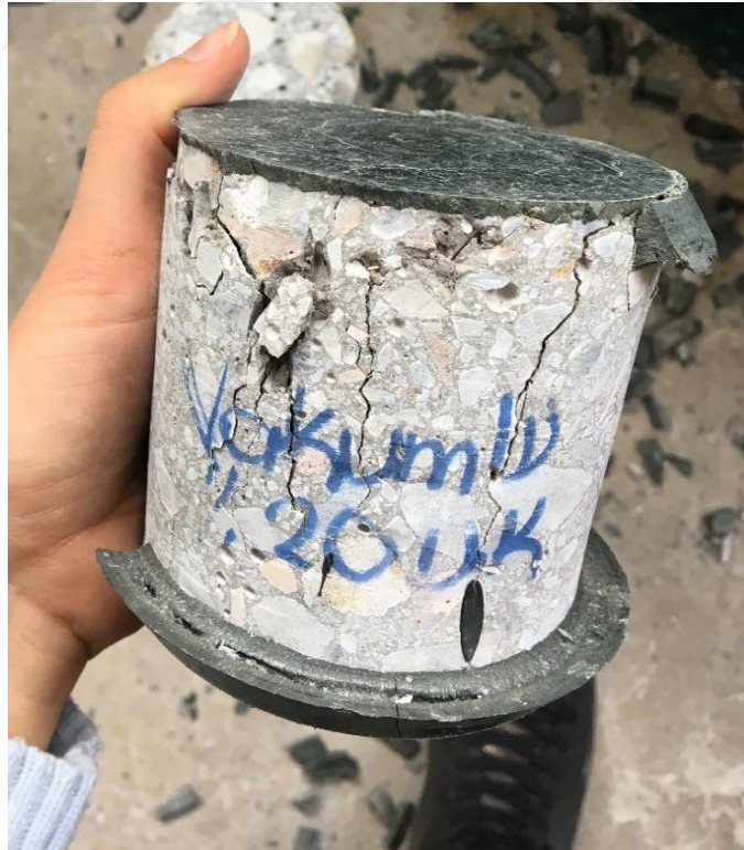
Şekil 4.2. 90 günlük donatısız karot numunesinin basınç dayanımı deneyi sonundaki durumu
