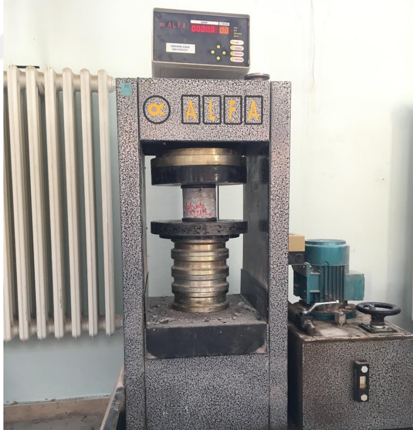
Şekil 3.27. Karot numunenin preste basınç dayanımının ölçülmesi
