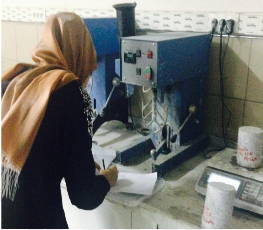
Şekil 3.38. Kılcal su emme deneyi için numunenin tartılma işlemi
