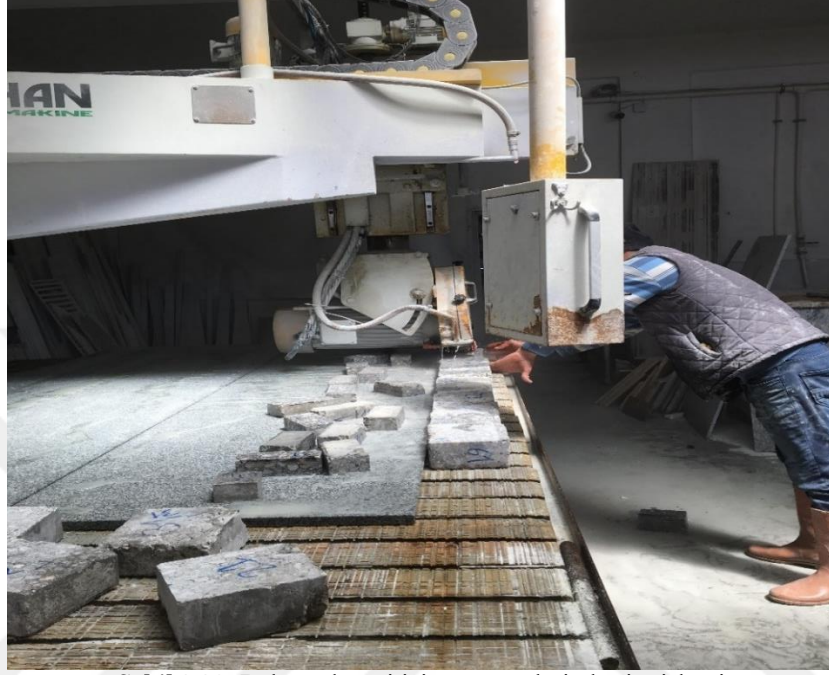
Şekil 3.32. Böhme deneyi için numunelerin kesim işlemi
