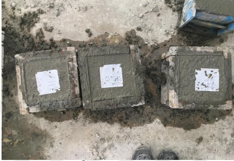
Şekil 3.12. Üretilen betonlardan 3'er adet numune alınması
