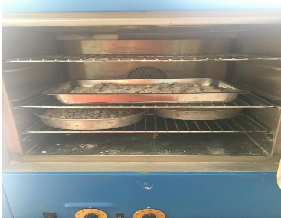
Şekil 3.3. Su emme tayini için agregaların 24 saat bırakıldığı etüv
