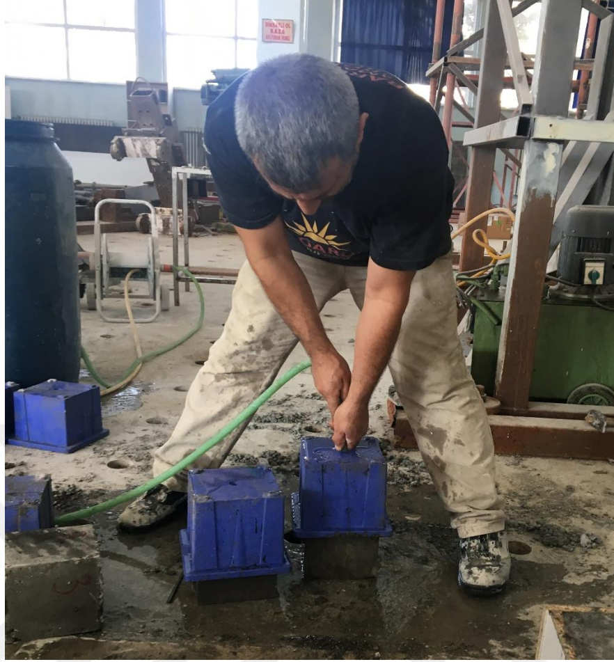
Şekil 3.21. Prizini alan numunelerin kalıptan çıkarılması
