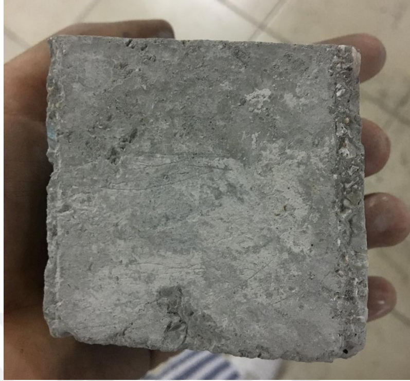
Şekil 3.35. Böhme deneyinde numunenin deneyden önceki hali
