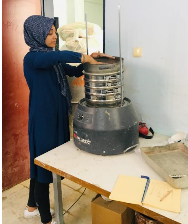
řekil 3.4. Beton gradasyonunun belirlenmesi iin elek analizinin yapılması
