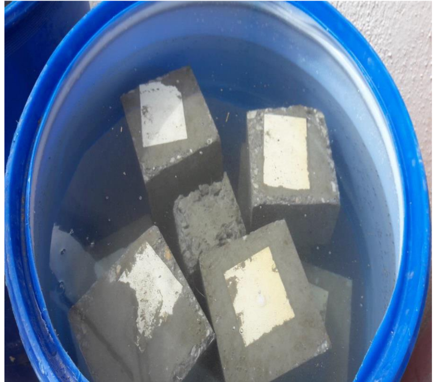
Şekil 3.22. Kalıptan çıkarılan numunelerin kür havuzuna konulması
