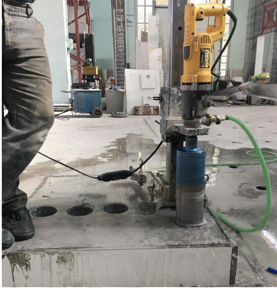
Şekil 3.24. Karot alma işleminin yapılması
