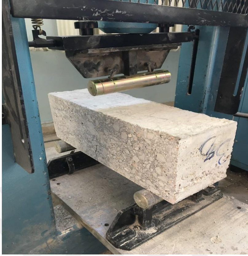
Şekil 3.30. Kiriş numunelerin preste deneye tabi tutulması
