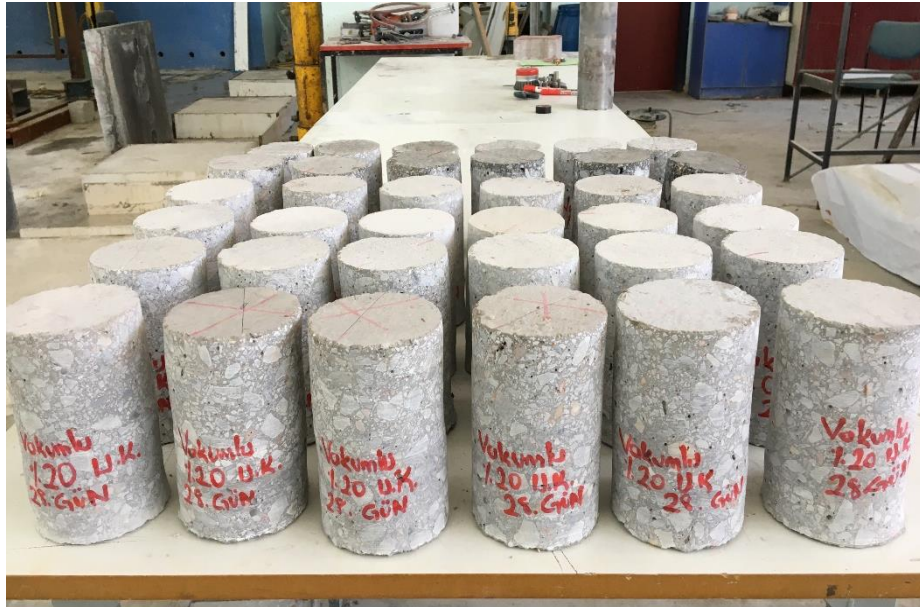
Şekil 3.25. 28. gün sonunda alınan karot numuneler
