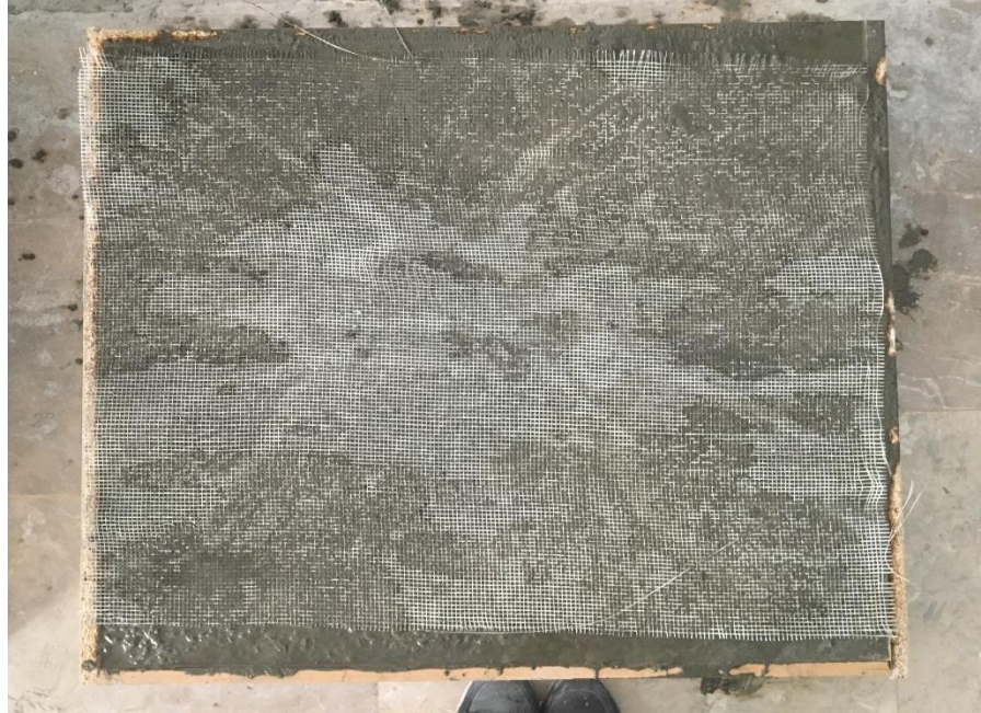
Şekil 3.13. Kalıplara yerleştirilen betonun vakum işlemi öncesinde üzerine örtü serilmesi
