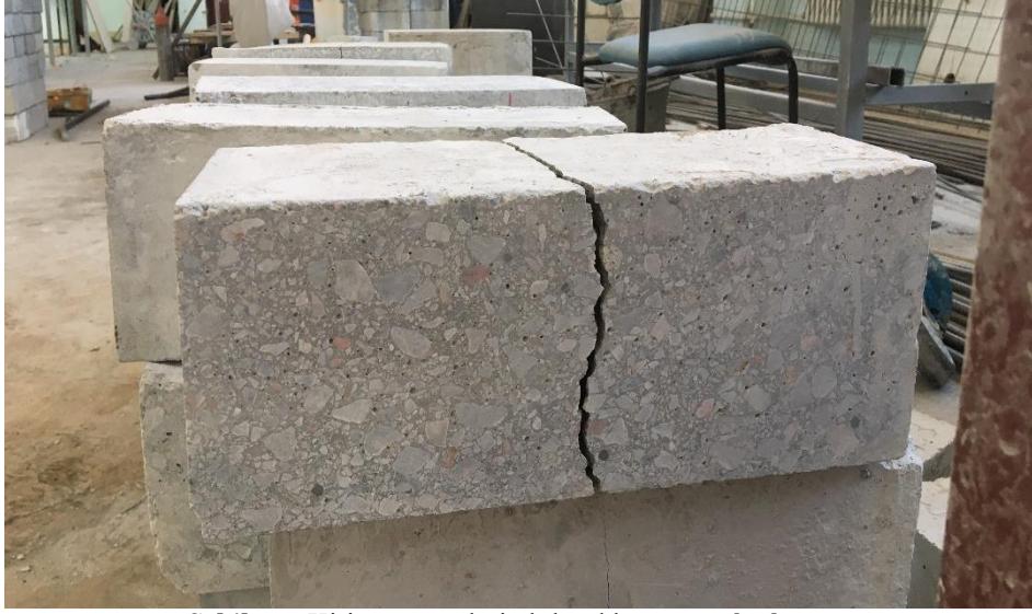
Şekil 4.7. Kiriş numunelerin kırıldıktan sonraki durumu
