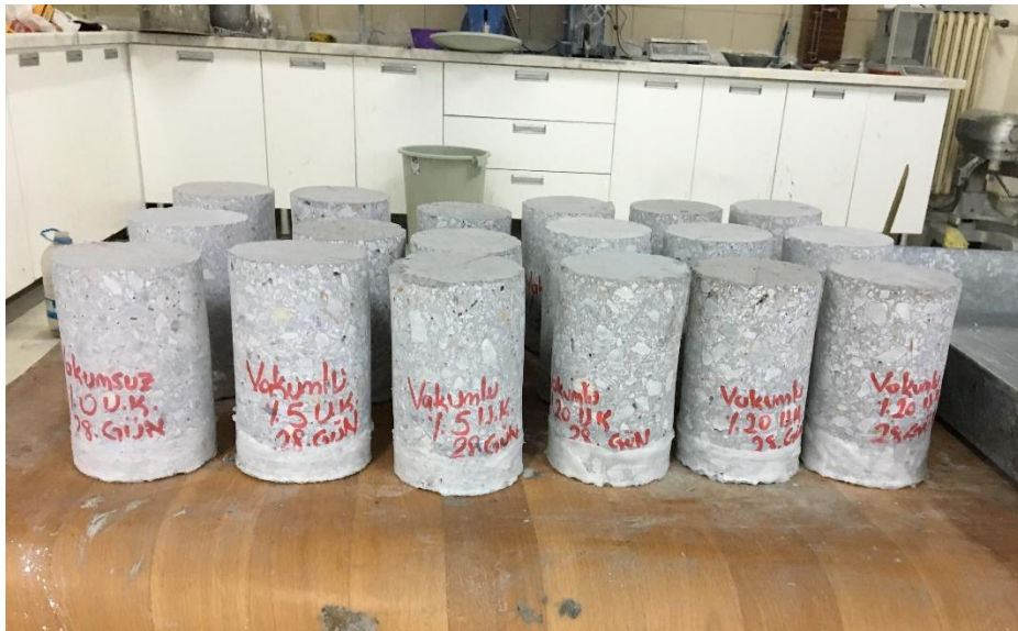
Şekil 3.37. Kılcal su emme deneyi yapılmadan önce parafinle kaplama işleminin yapılması
