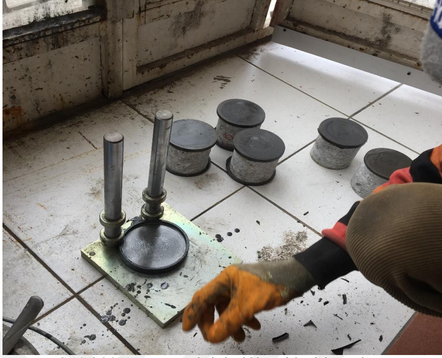
Şekil 3.26. Karot numunelerin başlıklama işleminin yapılması
