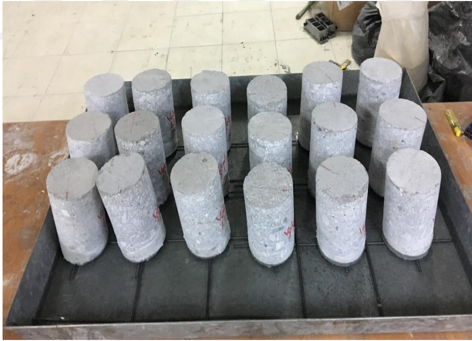
Şekil 3.39. Kılcal su emme deneyinin yapılması
