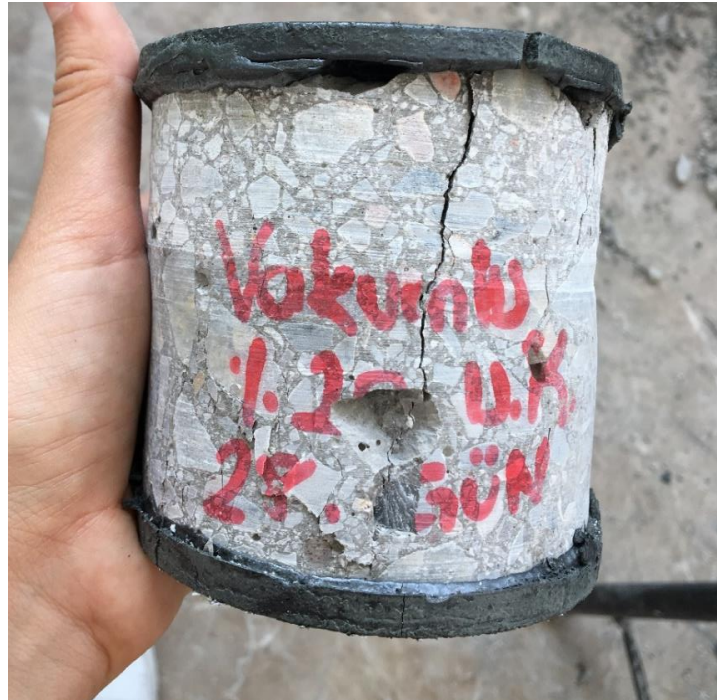
Şekil 4.1. 28 günlük donatılı karot numunesinin basınç dayanımı deneyi sonundaki durumu
