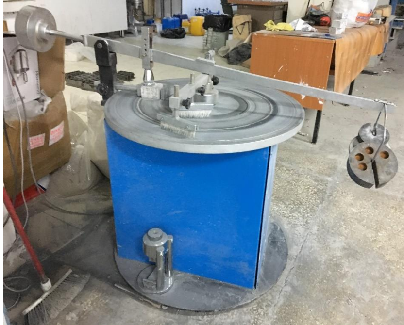
Şekil 3.33. Böhme deneyinin yapılma aşaması
