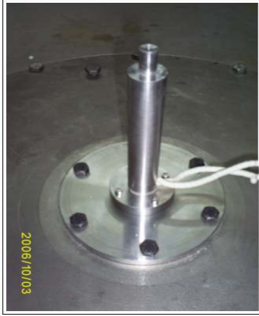
Resim 5.7. Çıkıntı aparatı - lüle bağlantısının görünümü [53]
