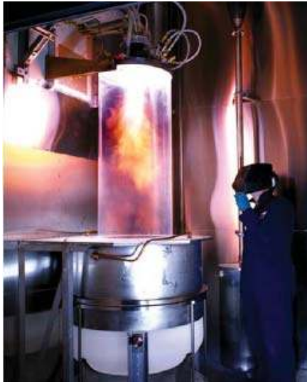
Resim 4.2. 100 kW güç ile çalışan indüktif bağlaşımlı ısı plazma sistemi reaktörü
