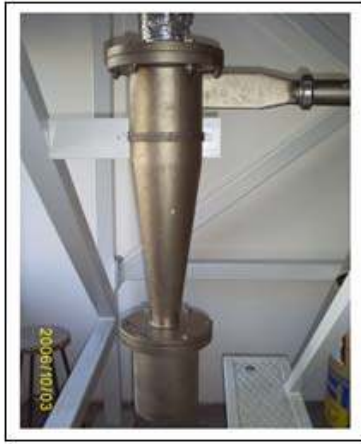
Resim 5.6. Siklon biriminin görünümü [53]
