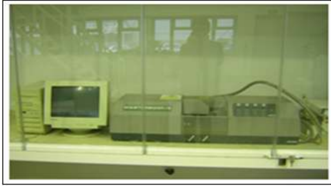
Resim 6.4. Malvern Mastersizer E parçacık boyutu ölçme cihazı
