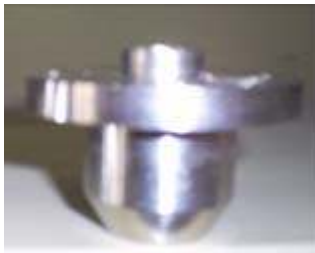
Resim 5.8. Çıkıntı aparatının görünümü ( h = 6 \text{ mm} ) [53]
