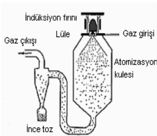
Şekil 5.1. Düşey gaz atomizasyon ünitesi [44]
