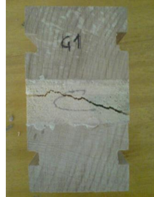
Resim 3.6. Üniversal test cihazı ve katmanlara dik yapışma direnci deneyi
