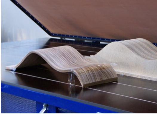
Resim 2.2. Vakumlu membran preste hazırlanmış lamine iş parçası [Columbus Maschinen, 2006] ve bir prototip geliştirme örneği -orta sehpa-
