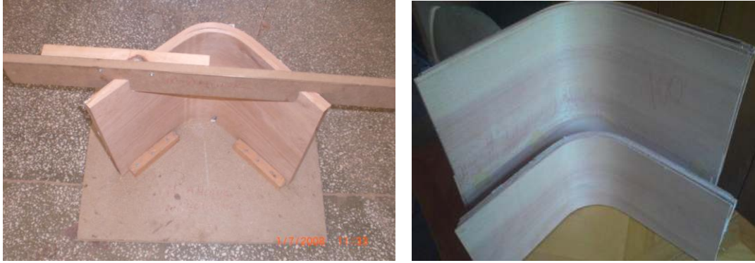
Resim 3.3. Pres sonrası özel kalıp (balans tablası) içerisinde bekletilen ve boyutlandırılma aşamasına gelmiş deney taslakları
