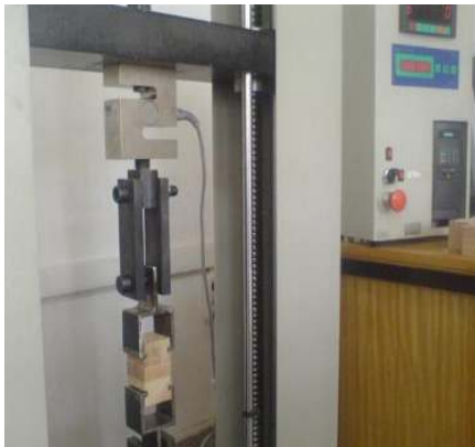
Resim 3.6. Üniversal test cihazı ve katmanlara dik yapışma direnci deneyi
