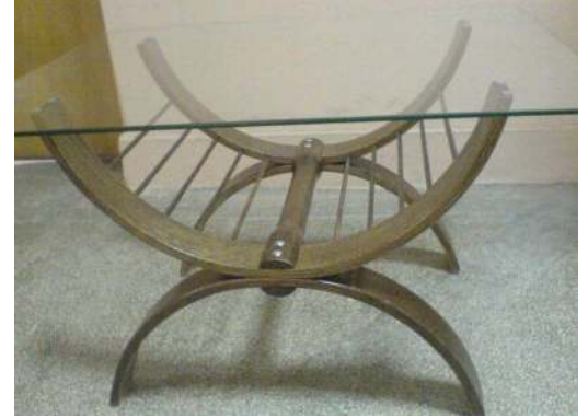
Resim 2.2. Vakumlu membran preste hazırlanmış lamine iş parçası [Columbus Maschinen, 2006] ve bir prototip geliştirme örneği -orta sehpa-
