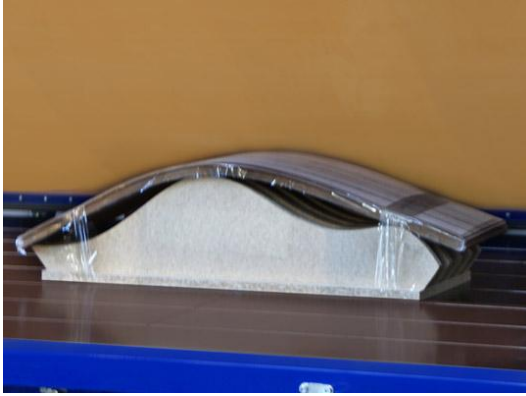
Resim 2.1. Vakumlu membran preste lamine iş parçası hazırlama aşamaları [Columbus Maschinen, 2006].
