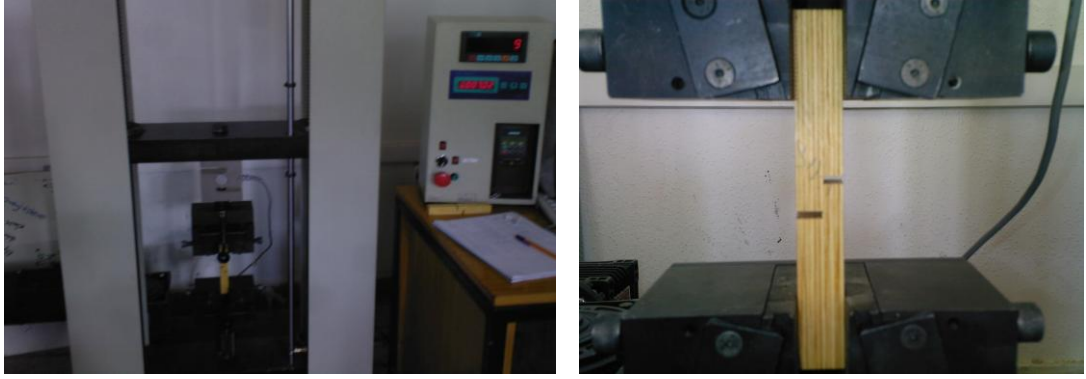
Resim 3.4. Katmanlara paralel yapışma direnci deneyi
