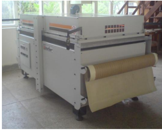
Resim 2.6. Hem membran kapak hem de şekillendirilmiş lamine ahşap işlemlerinde kullanılabilen vakumlu Membran pres makinesi [Sabır Makine, 2006].
