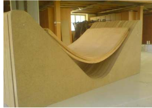
a. 20 mm yarıçaplı dış bükey kavisli kalıp b. 100 mm yarıçaplı iç bükey kavisli kalıp
