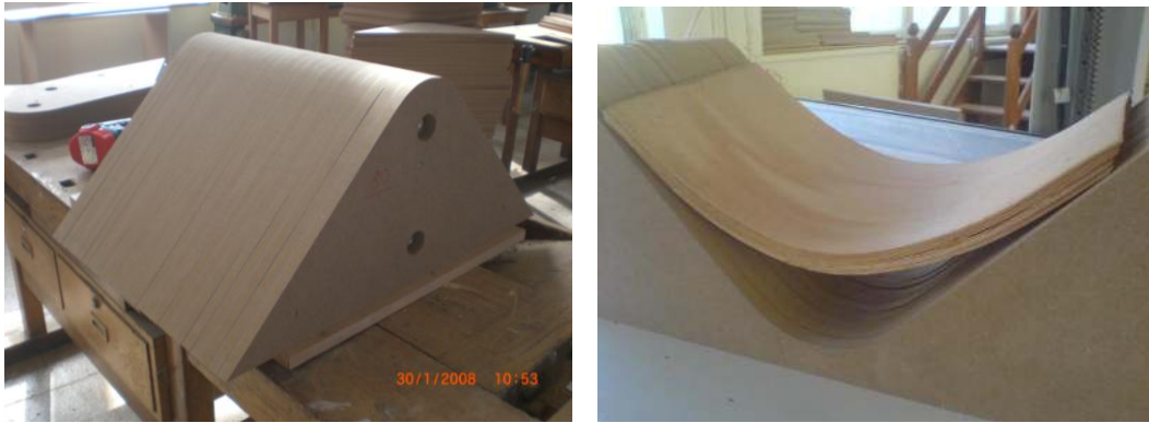
Resim 3.2. 80 mm yarıçaplı dış bükey ve 100 mm yarıçaplı iç bükey kalıp örnekleri
