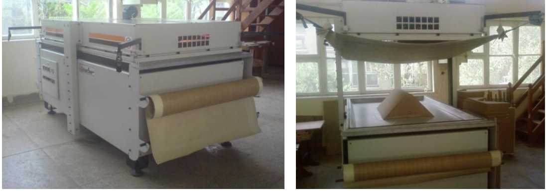
Resim 3.1. Vakumlu membran pres makinesi ve preste kullanılan kalıp örneği
