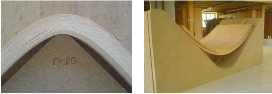
Resim 4.2. Üretimi mümkün olmayan 20 mm yarıçaplı dış bükey ve iç bükey kavis
