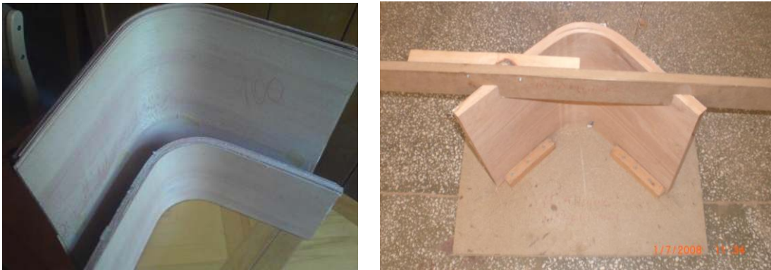
Resim 4.5. Boyutlandırılmamış deney örnekleri ve deformasyonu engellemek için kullanılan kalıp
