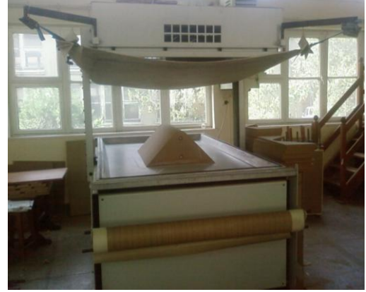
Resim 2.6. Hem membran kapak hem de şekillendirilmiş lamine ahşap işlemlerinde kullanılabilen vakumlu Membran pres makinesi [Sabır Makine, 2006].
