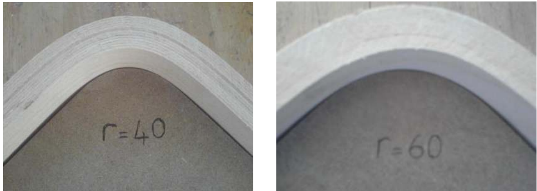
Resim 4.3. Elde edilebilen dış bükey kavis değerleri
