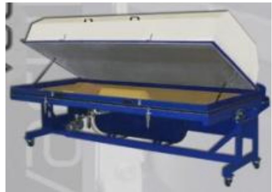
Resim 2.7. Hem membran kapak hem de şekillendirilmiş lamine ahşap işlemlerinde kullanılabilen vakumlu Membran presler [Fernan ve Columbus, 2006].
