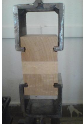
Resim 3.6. Üniversal test cihazı ve katmanlara dik yapışma direnci deneyi
