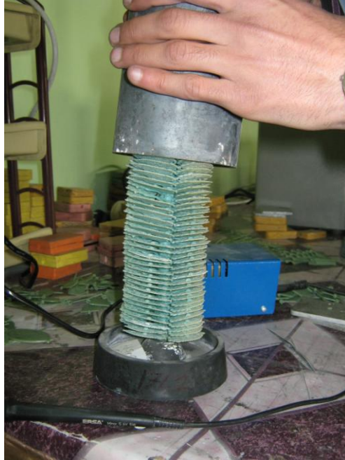
Şekil 55-Mum Kalıplarının Alçıya Alınması
