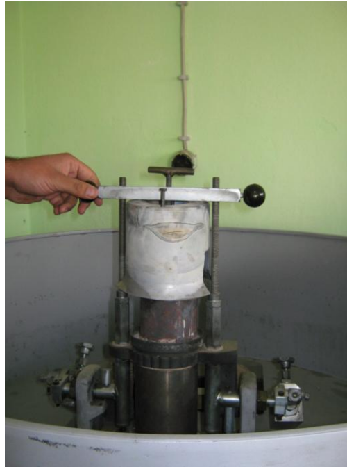
Şekil 59-Gümüşün Alçıya Enjekte Olması
