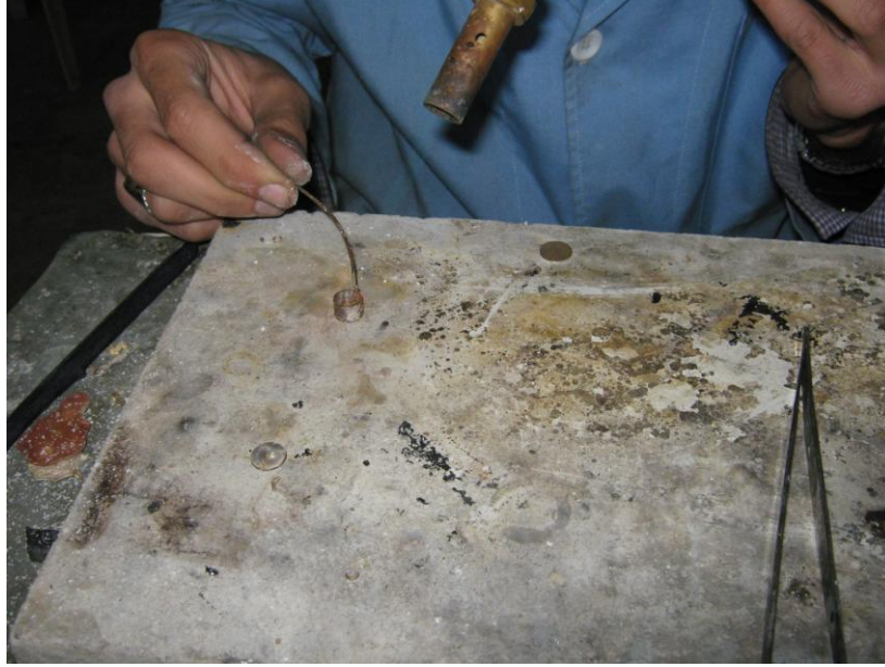
Şekil 64-Gümüşe Kaynak Yapımı
