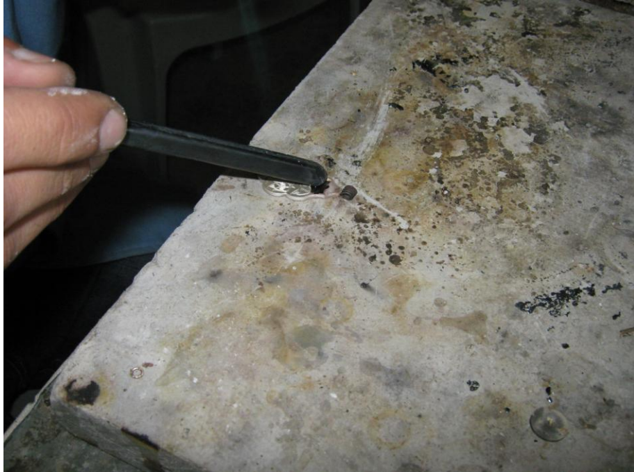
Şekil 67-Savatın Gümüşe Sürülerek Uygulanması
