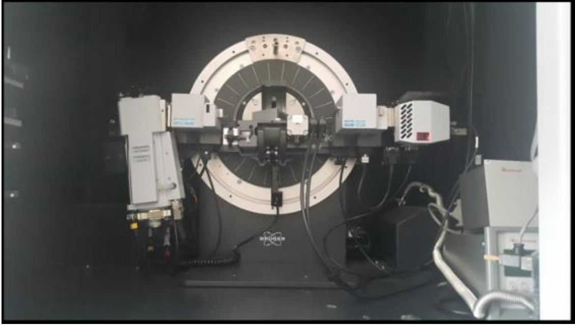
Şekil 2. 10. X-ışını kırınımı Difraktometresi (XRD) (Al-gburi, 2018)
