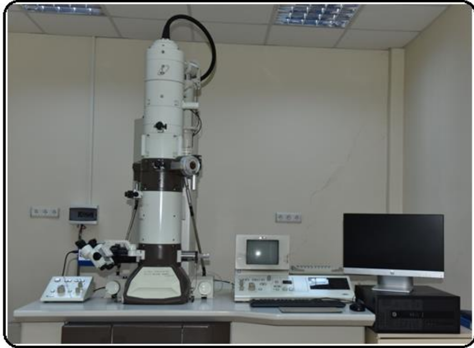
Şekil 3. 6. AgNP'lerin morfolojik yapılarının incelenmesinde kullanılan TEM cihazı görüntüsü
