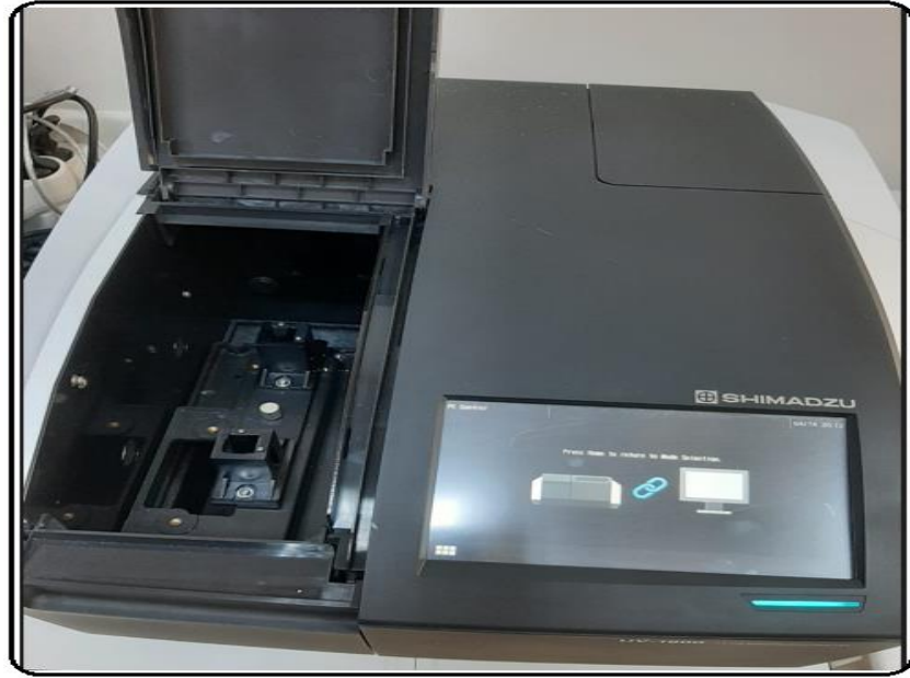
Şekil 3. 4. AgNP'lerin oluşum ve varlığının değerlendirilmesinde kullanılan UV-vis cihaz görüntüsü
