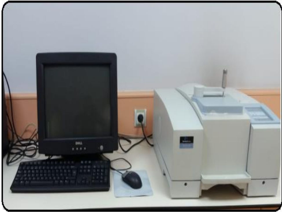
Şekil 3. 10. A. schoenoprasum özüt içeriğinde biyoaktif bileşenlerin fonksiyonel gruplarının belirlenmesinde kullanılan FTIR cihazı görüntüsü
