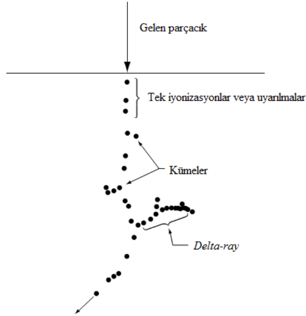
1 Şekil 2 Delta-ray'ın şematik gösterimi
