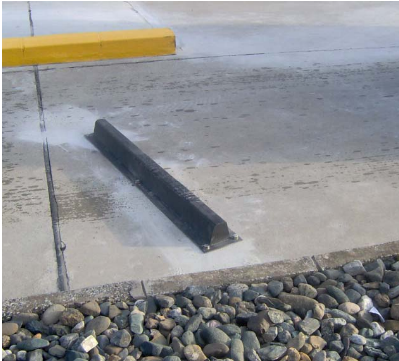
Resim 5.3. Kaldırım çarpma testi -115 mm yüksekliğindeki kaldırım
