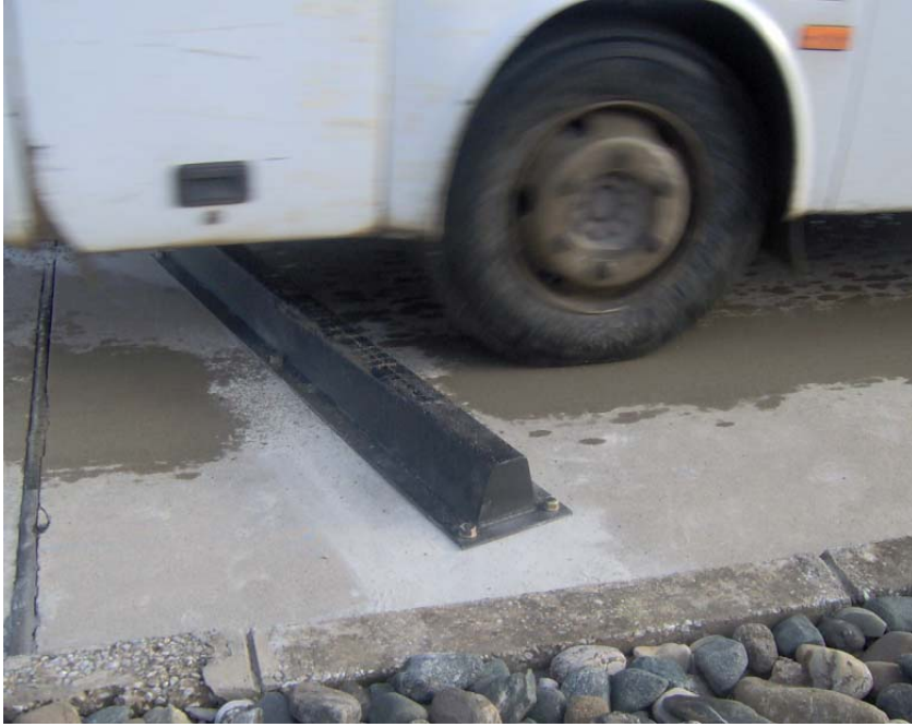
Resim 5.4. Kaldırım çarpma testi-Sol tekerlek
