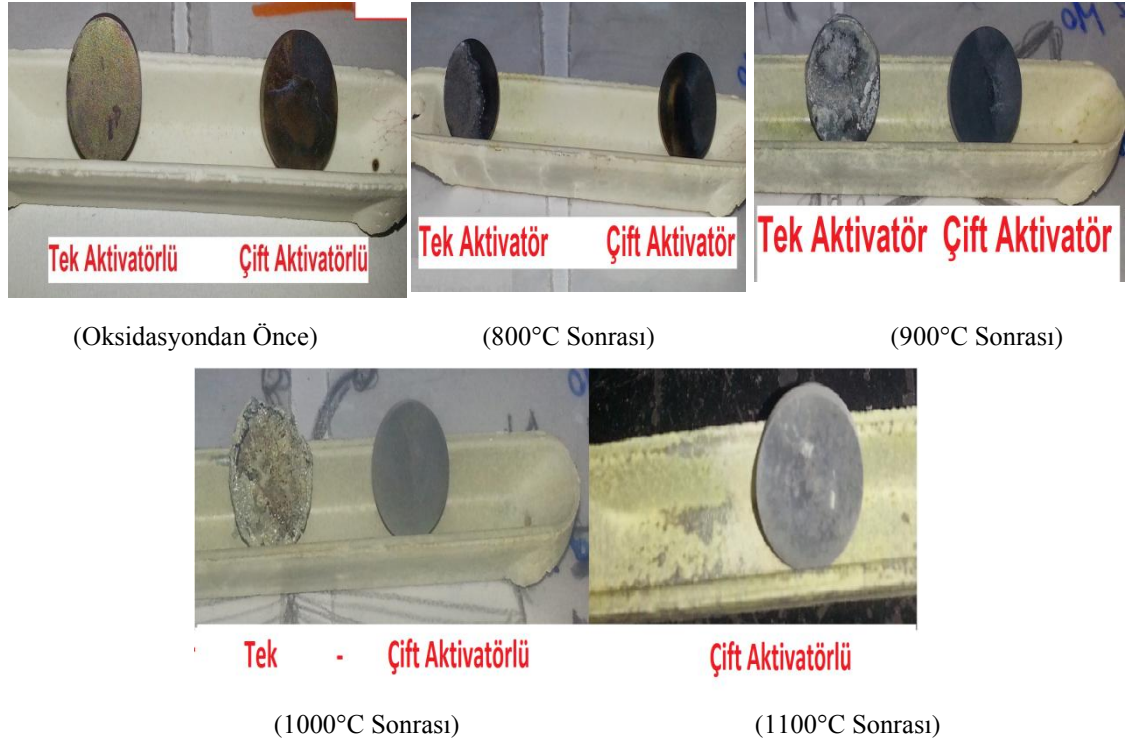
Şekil 4.31 Çift ve tek aktivatör kullanılarak ortak biriktirme amacıyla semente edilmiş Mo metalleri.
