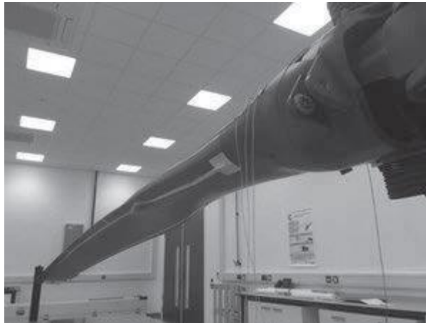
Şekil 2.10. Bladesense projesi kapsamında kurulan sensör ağı (Günaydın vd. 2019)
