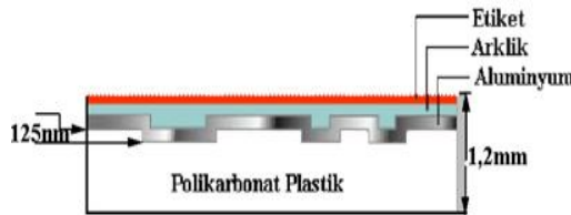
Şekil 15. Veri kaydı yapılmış CD-ROM'un malzeme yapısı
