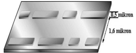
Şekil 16. CD-ROM'un yüzey yapısı
