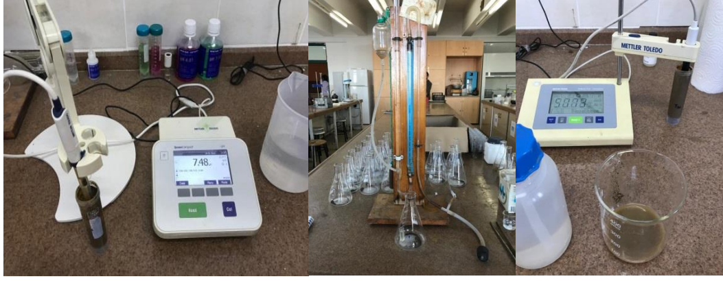
Şekil 3. 4. Toprakların pH, EC ve kireç( \text{CaCO}_3 ) değerlerinin ölçülmesi
