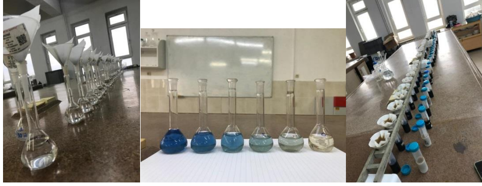
Şekil 3. 6. Değişebilir katyonların analizi için süzük alma işlemleri ve fosfor analizi için hazırlanan standart çözeltiler
