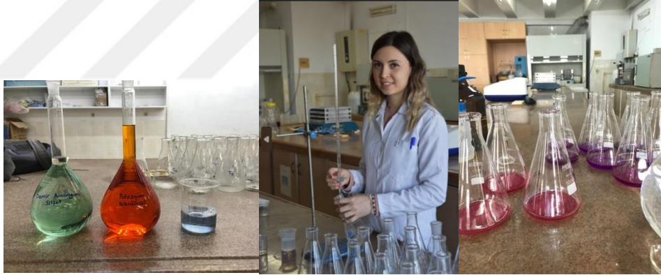
Şekil 3. 5. Organik madde analizi için hazırlanan çözeltiler, titrasyon işlemi ve sonucu renk değişimi
