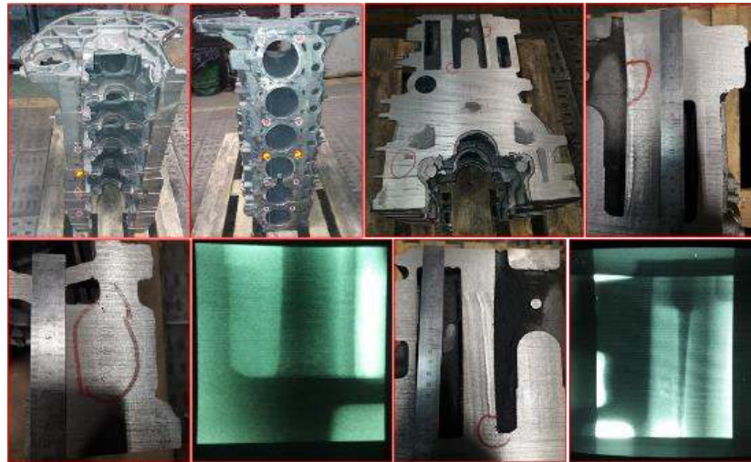
Şekil 4.11 : İşaretli bölgelerde kafa bağlama deliği delinince çıkacak konumda CC3 ve CC4 seviyeli çekintiler
