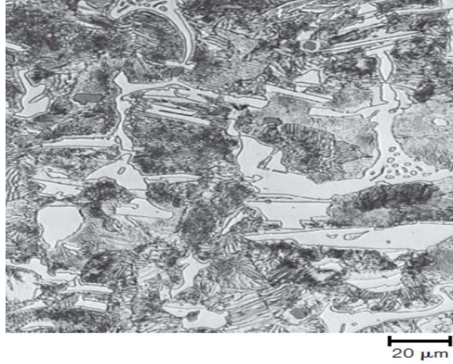
Şekil 2.7 : Beyaz dökme demire ait mikroyapı fotoğrafı. Açık renkli bölgeler sementit, koyu renkli bölgeler ise perlit [12]
