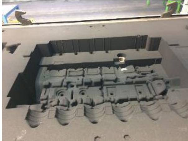
Şekil 3.2 : Alt derecenin maça yerleştirilmeden önceki görüntüsü
