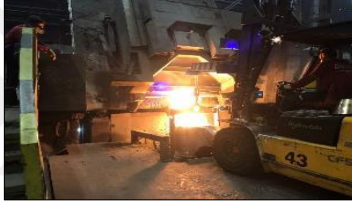
Şekil 3.6 : Küreleştirici ve aşılavıcı konulan sandviç tipi döküm potası, forklift ile indüksiyon ocağının önüne konulur ve üzerine sıvı metal dökülür ve tretman başlamış olur.
