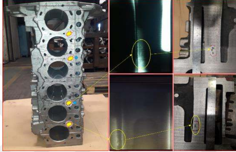
Şekil 4.5 : İşaretli kesitlerde kafa bağlama deliklerinden uzakta yaklaşık 130 mm derinlikte sızdırmaya neden olmayacak konumda (kep yağlama kanalından uzak) CC3 ve CC4 seviyeli çekintiye rastlanmıştır.
