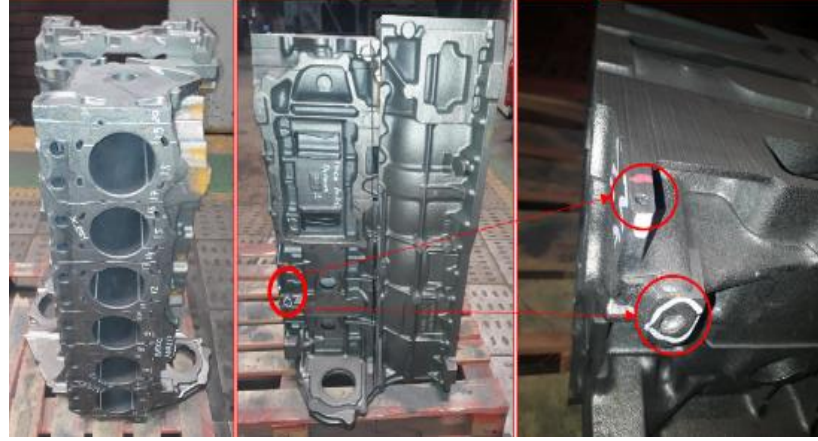
Şekil 4.14 : DDL – 200 madeni ile dökülen parçadaki gaz hataları
