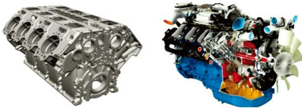
Şekil 2.49 : Scania V8 vermiküler grafitli dökme demir motor bloğu (solda) ve motoru (sağda) [52]
