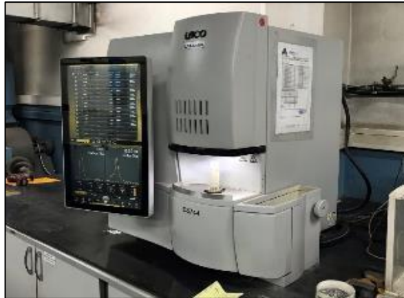
Şekil 3.16 : LECO CS 744 karbon – kükürt analiz cihazı
