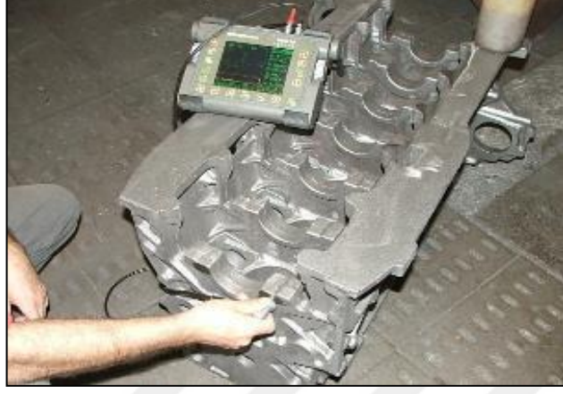
Şekil 3.25 : Deneme dökülen motor bloklarından ses hızı ölçümü
