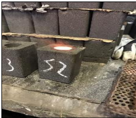
Şekil 3.12: Küresellik numunesi maçaları
