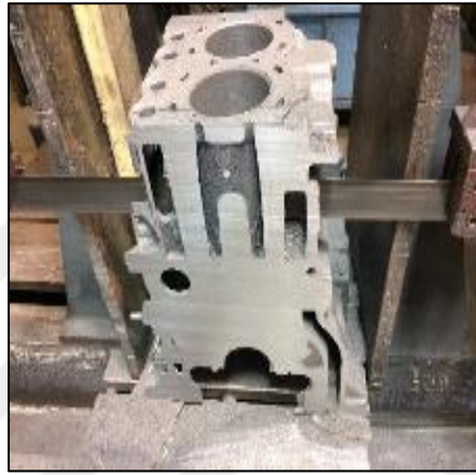
Şekil 3.26 : Parçaların testere ile kesilmesi
