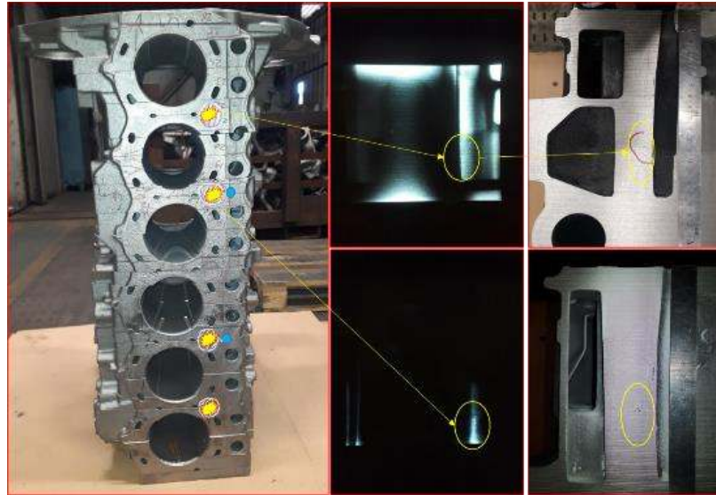
Şekil 4.6 : İşaretli kesitlerde kafa bağlama deliğinden uzakta yaklaşık 130 mm derinlikte sızdırmaya neden olmayacak konumda (kep yağlarından uzak) CC2 seviyeli mikro gözenekli çekintiye rastlanmıştır. Diğer kesitlerde hataya rastlanmamıştır.
