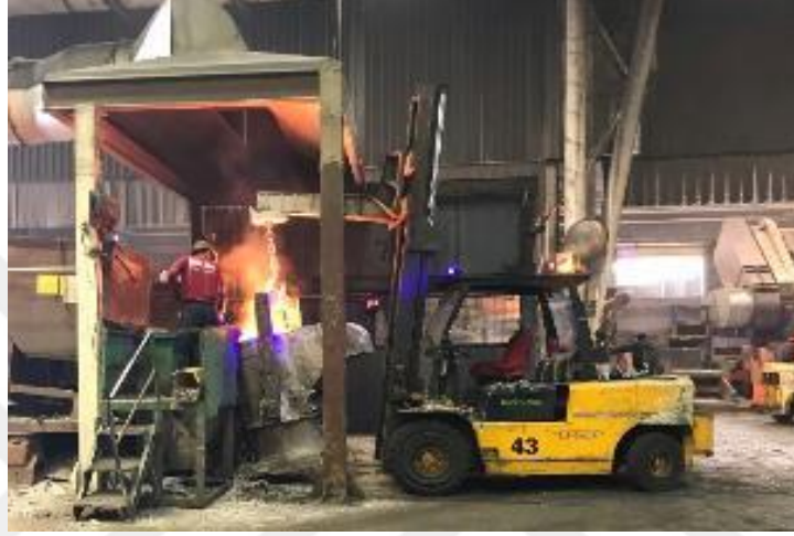
Şekil 3.7 : Cüruf temizleme istasyonu
