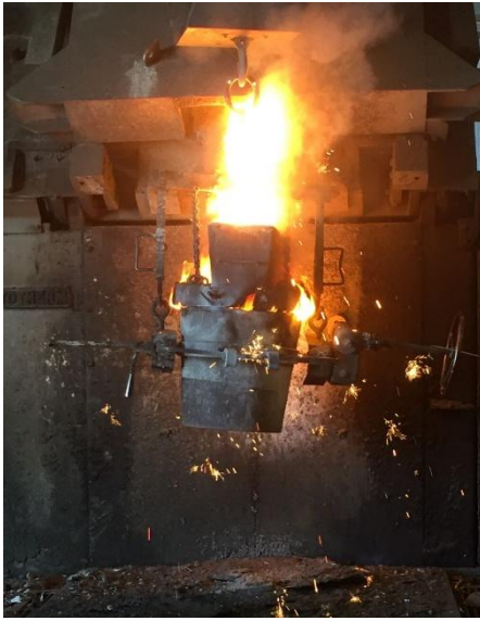
Şekil 3. 2 Inductotherm İndüksiyon Ocağı, Tandış Pota İşlemi ve Teknik Resmi.
