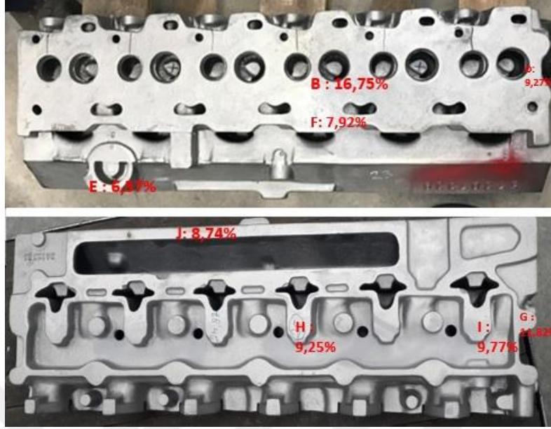
Resim 4. 26 Tandiş Pota ile Dökülen Parça.
