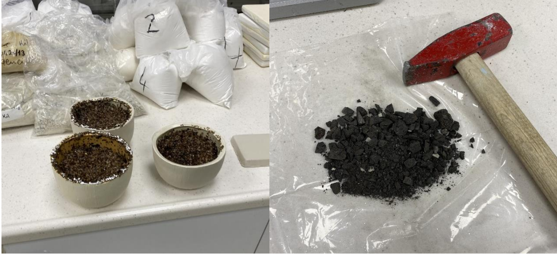
Resim 3.2 Vermikülitin ergitme işlemi sonrası katkı maddesi olarak hazırlanma süreci.
