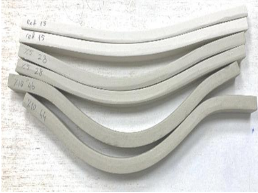
Resim 3.1 Vermikülit katkısının neden olduğu deformasyon görüntüleri.
