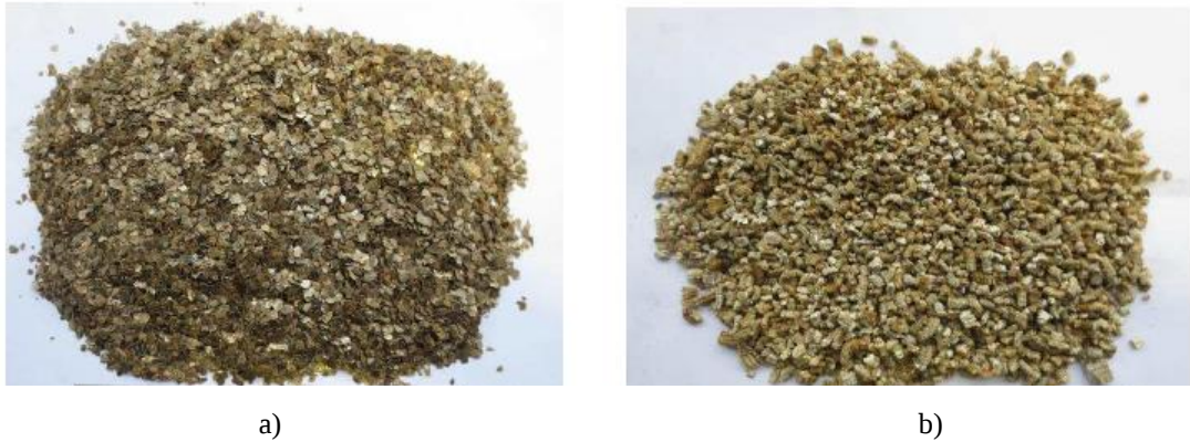
Şekil 2.3. a) Orta dereceli Brezilya Ham vermikülit, b) Orta dereceli Brezilya genleştirilmiş vermikülit [38].
