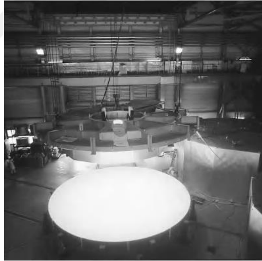
Şekil 3.34. Zerodur cam-seramik 8,2 metre çapında teleskop aynasının üretimi [11].
