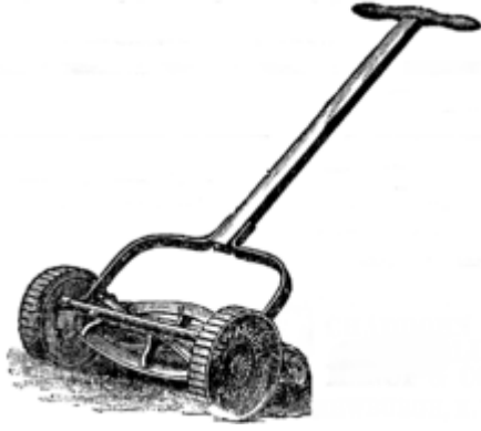
Şekil 5.1. Arka silindir ve tekerlek tahrikli döner bıçakları önünde sabit bir kesme bıçağı göstererek mekanik silindir (reel) biçmemakinesi[15]
