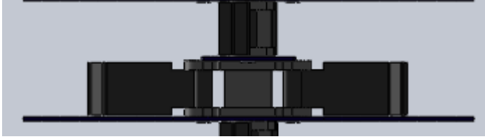
Şekil 7.20. Montaj halinde çim biçme bıçağı ile verticut bıçağının yan yana görüntüsü
