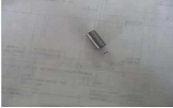
Şekil 7.6. Bıçak üstü bıçak pimi geçecek olan parça
