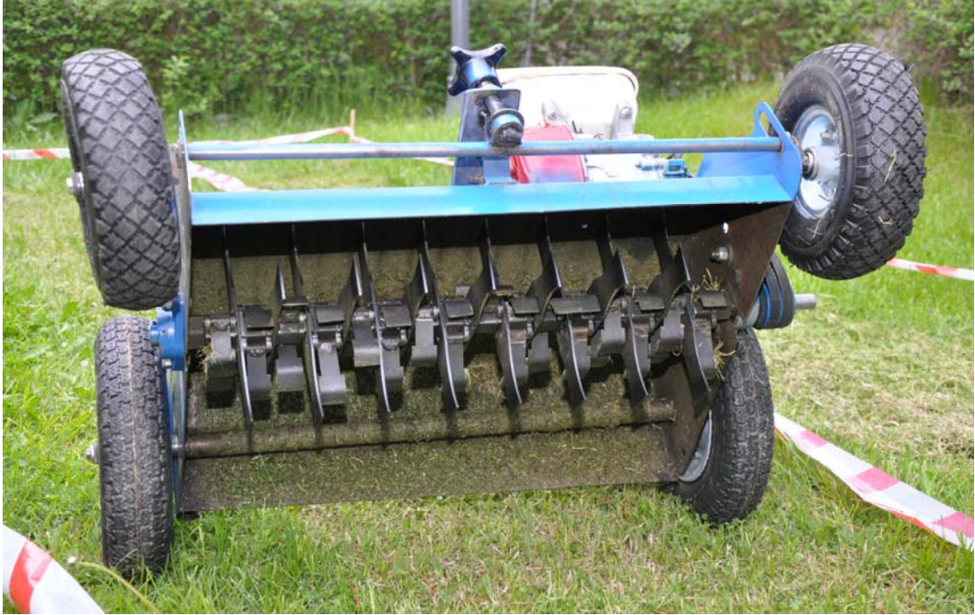
Resim 7.11. Makinenin alt bıçak sisteminin biçimden sonra görüntüsü
