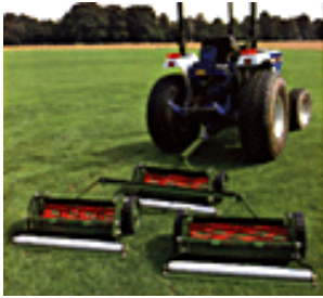
Resim 5.2. Traktör arkası silindirik biçici masif [15]
