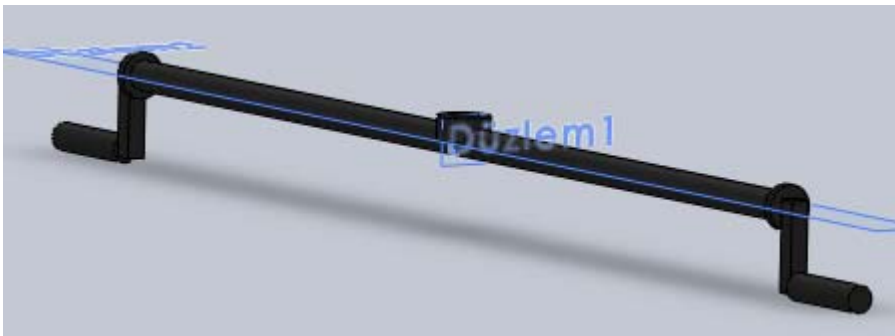
Şekil 7.39. Yükseklik ayar gidonuna bağlı ön dingil
