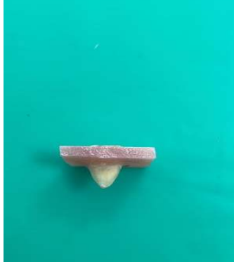
Resim 3. Örnekler apeksi açıkta kalacak şekilde akrile gömülüdür.
