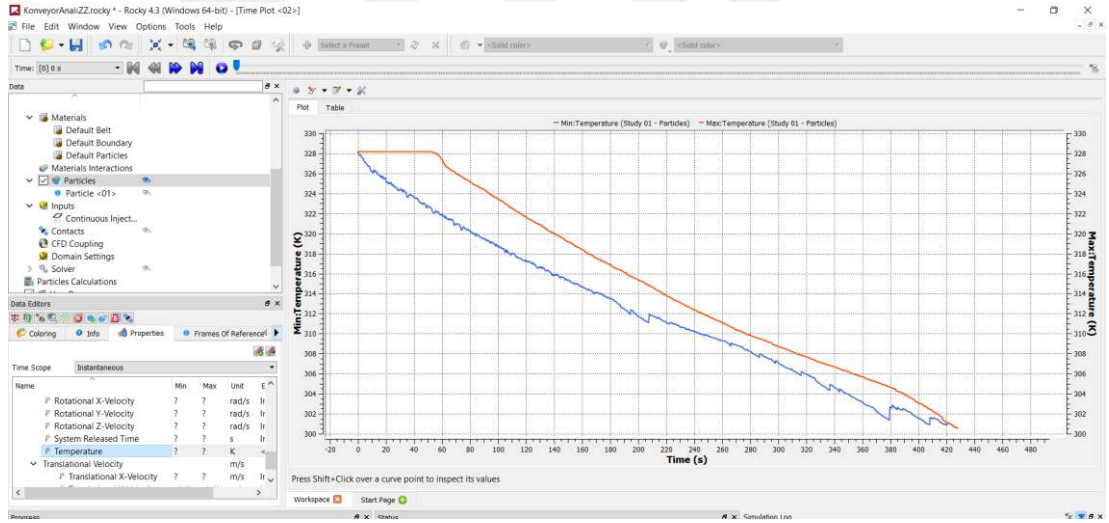
Şekil 43. Vibrasyonlu Dikey Helezon Konveyör Helezon çapı 700mm, Titreşim Frekansını 20Hz Sıcaklık Sonucu
