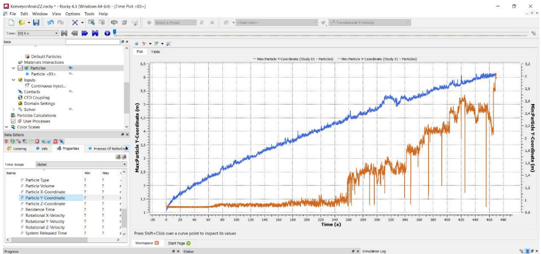
Şekil 41. Vibrasyonlu Dikey Helezon Konveyör Helezon çapı 700mm, Titreşim Frekansını 20Hz Yer Değişirme Sonucu
