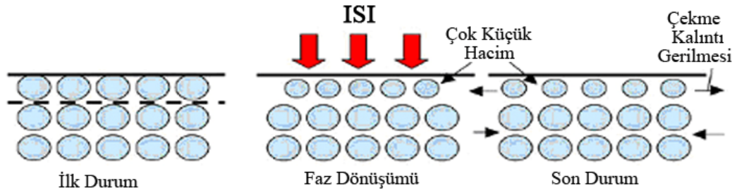
Şekil 4.1. Griffiths'e göre bileşen yüzeyinde oluşmuş kalıntı gerilmeler üzerine termal faz dönüşümünün etkisi [160]
