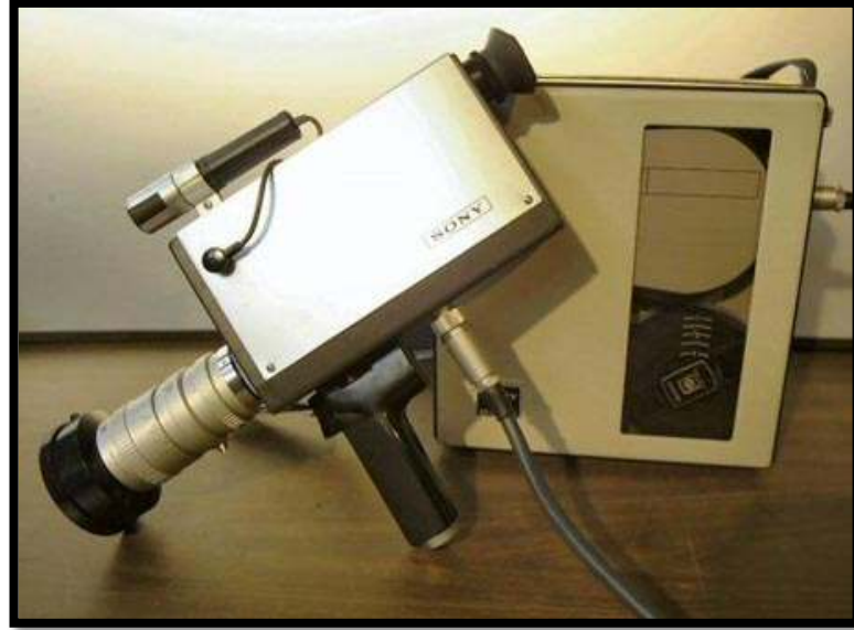
Resim 39: Sony Portapak, Batarya (Pil) İle Çalışabilen İlk Video Sistemi (Kamera ve Video Kayıt Cihazı), 1967
